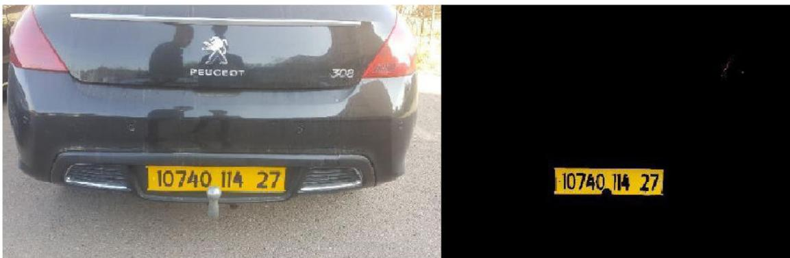
*figure III.3* : Détection de plaque d'immatriculation par couleur
