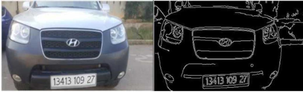
Figure III.4 Détection de plaque d'immatriculation par contour
