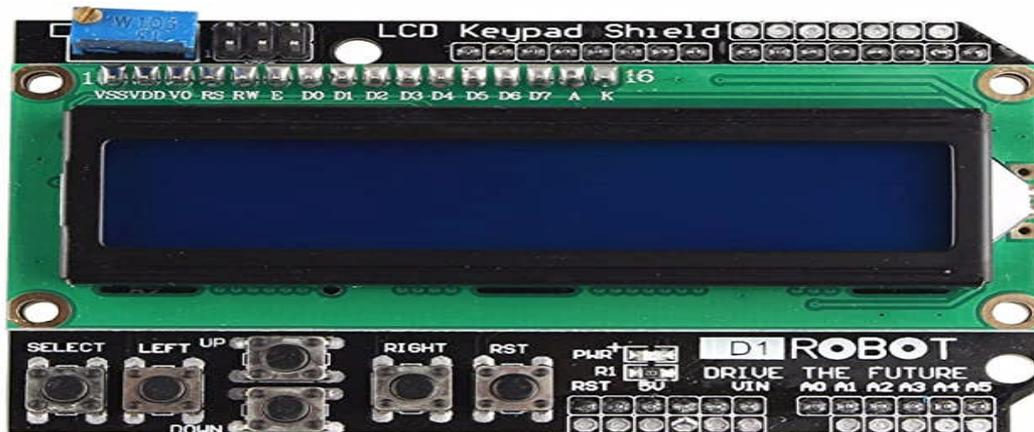
Figure III.11. Afficheur LCD
