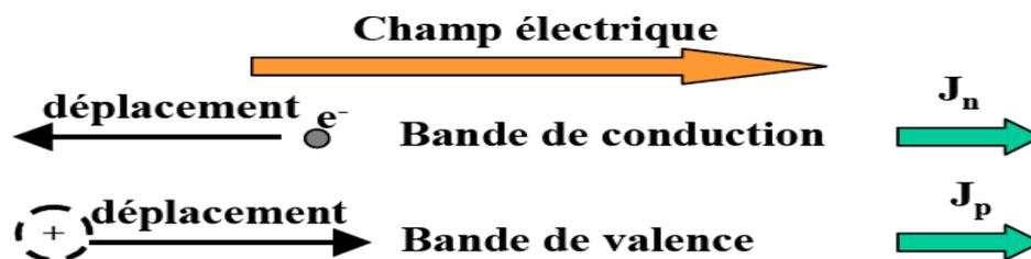
**Figure I-1** : Représentation symbolique du mécanisme de conduction et de conduction dans les bandes de valence .
