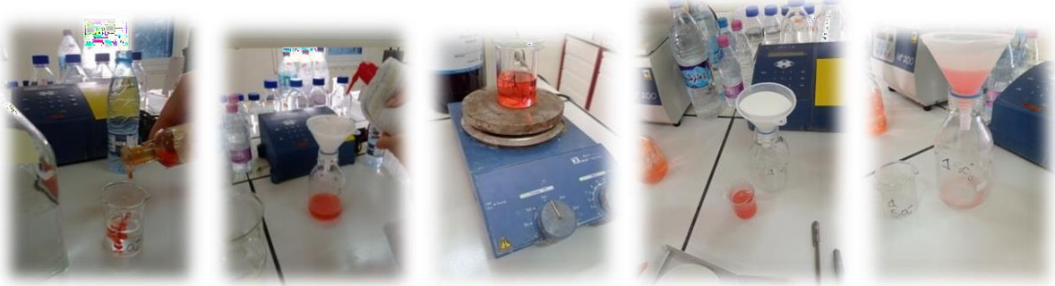
Photo 23: dosage de sulfate \text{SO}_4^- (photo original).
