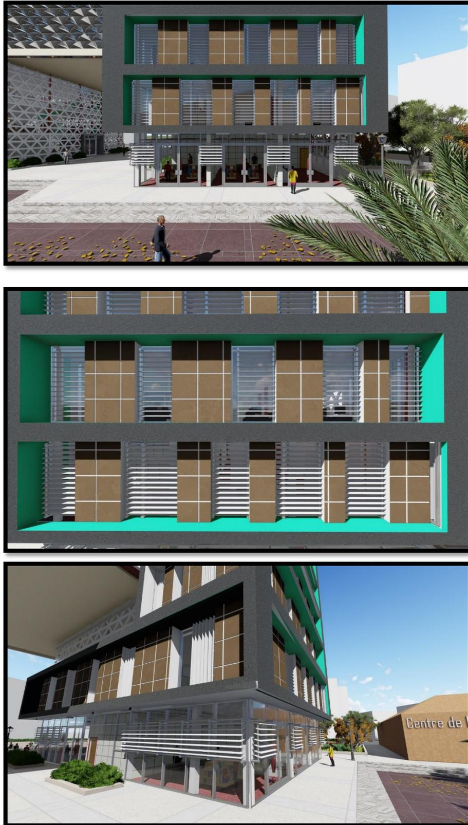
Figure 33: Traitement de la façade Sud avec une protection solaire horizontale
