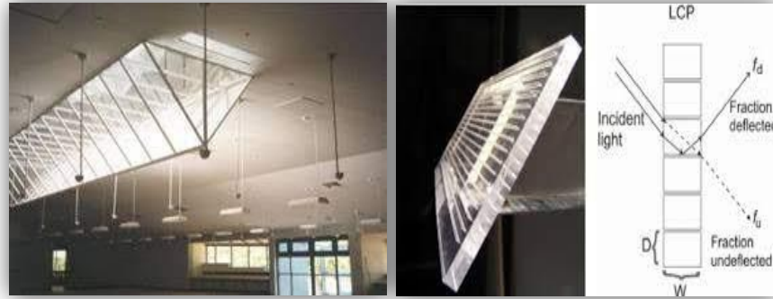
الشكل 11: المناوير ذات الألواح المقطوعة بالليزر
