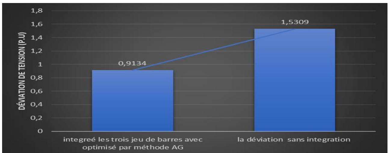
Figure IV.40: Comparaison des résultats en termes de valeur des déviations de tension totale, sans et avec intégration de trois sources PV
