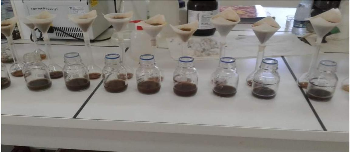
**Photo 24** : la filtration des échantillons après l'agitation.
