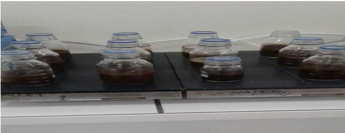
**Photos 23 :** Agitation des échantillons pour l'analyse du phosphore assimilable.
