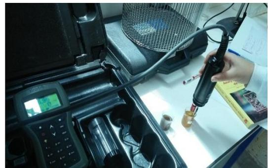
**Photo 21** : Mesure de la conductivité électrique.
