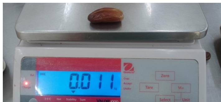
Figure 55 : Mesure du poids d'une datte après le trempage dans l'eau osmosée.
