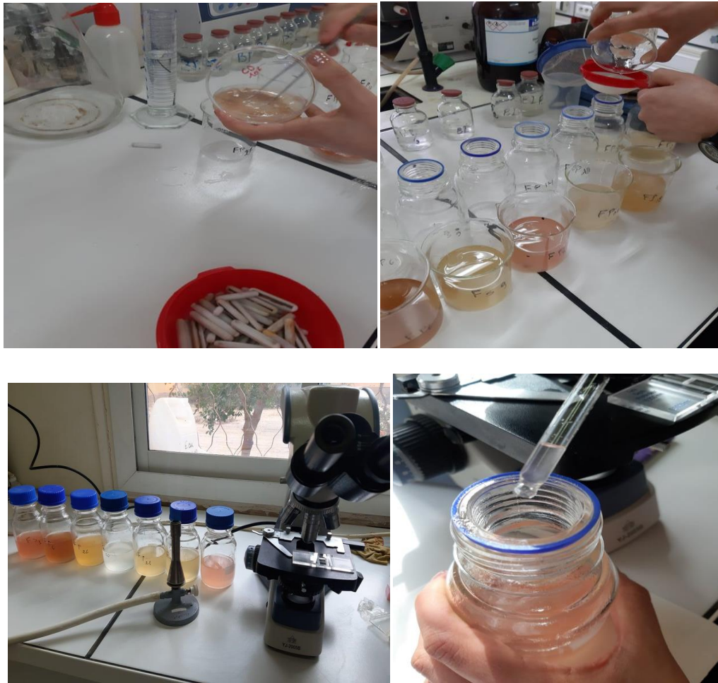
Fig.9 : contage des concentrations pour l'inoculation avec la cellule Malassez
