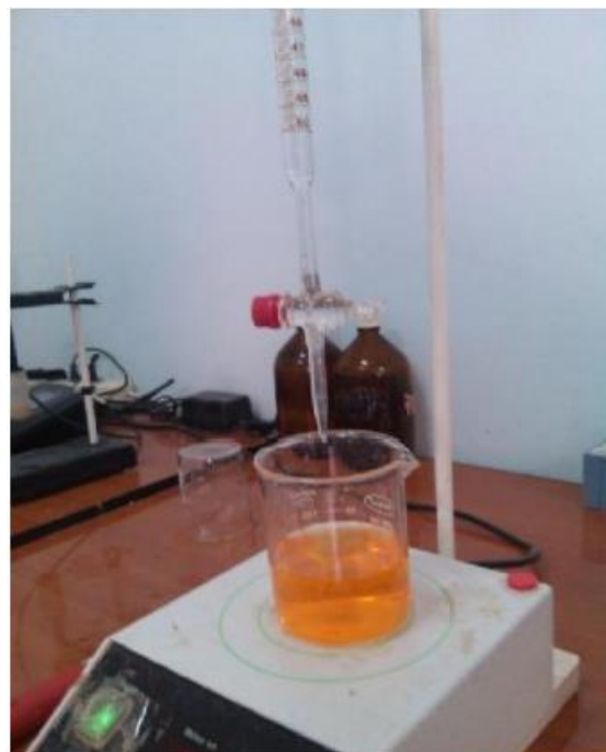
Figure 23 : photo titrage de \text{Cl}^- à la fin
