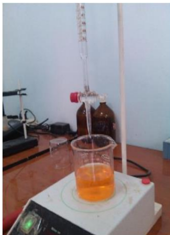
Figure 21 : photo de titrage de ( \text{HCO}_3^- )
