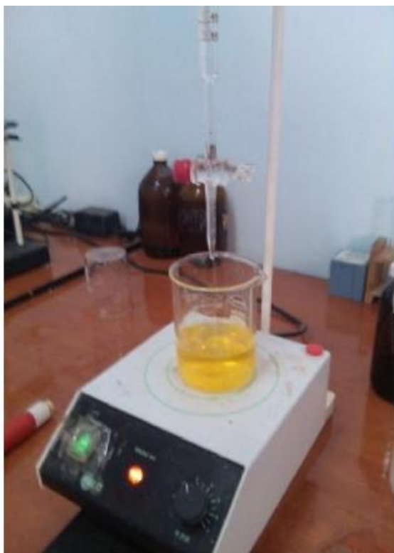
Figure 20 : photo de titrage de ( \text{HCO}_3^- )
