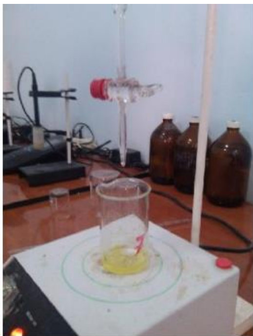
Figure 18 : photo de titrage de (Mg^{2+}) .
