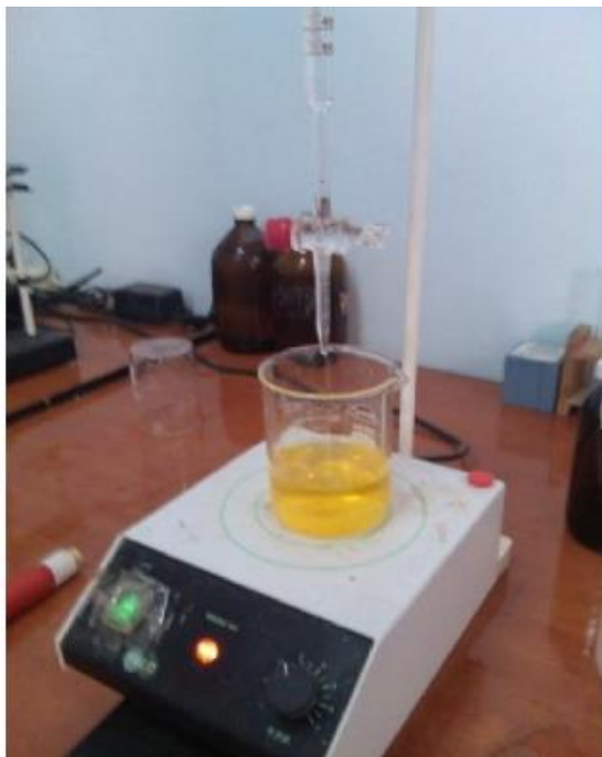
Figure 22 : photo de titrage de \text{Cl}^-
