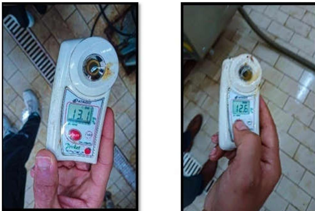
*Figure 13: Appareil de mesure de taux de brix (photo original).*
