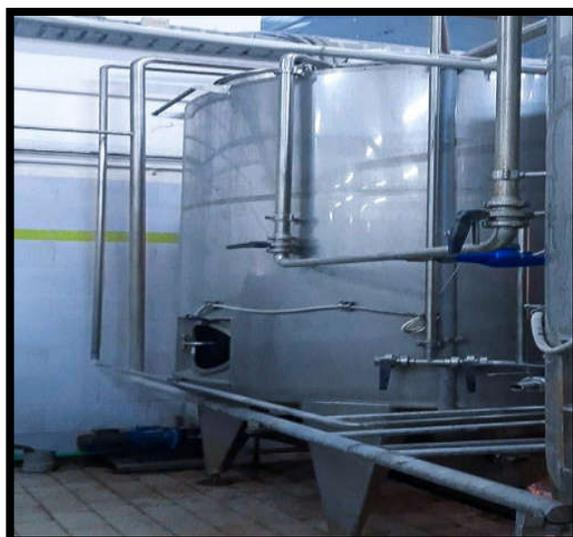
**Figure 9:** Pasteurisation par l'Autoclave (photo original).
