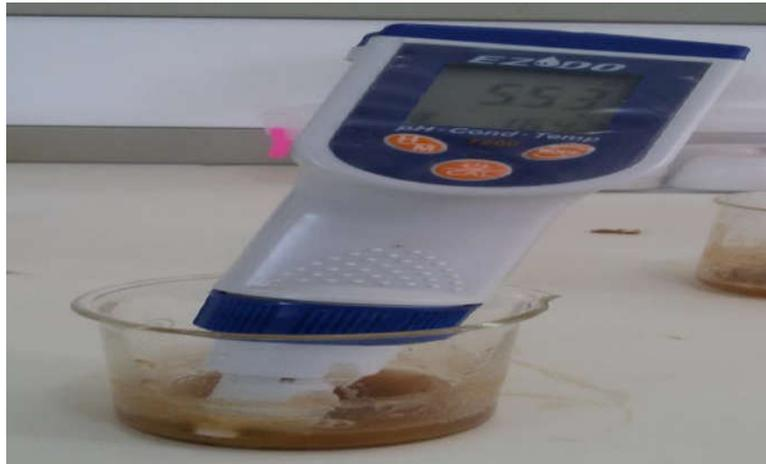
**Figure 7.** Mesure de pH de l'échantillon à l'aide d'un pH- mètre.
