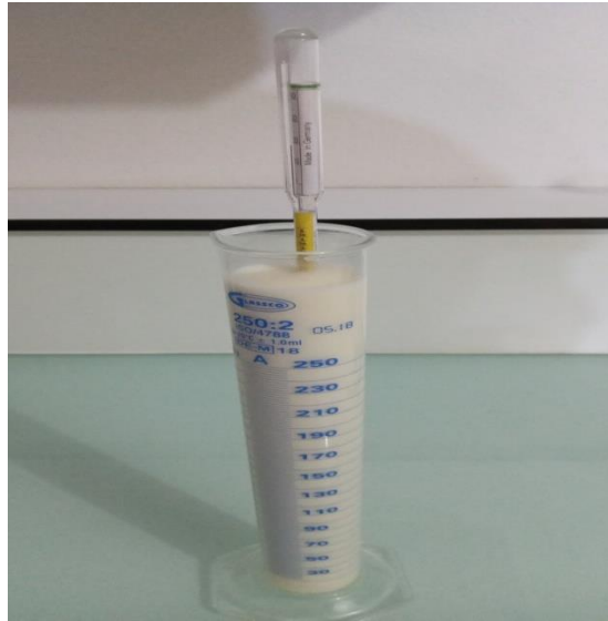
Figure 04: mesure la densité du lait cru par un lactodensimètre
