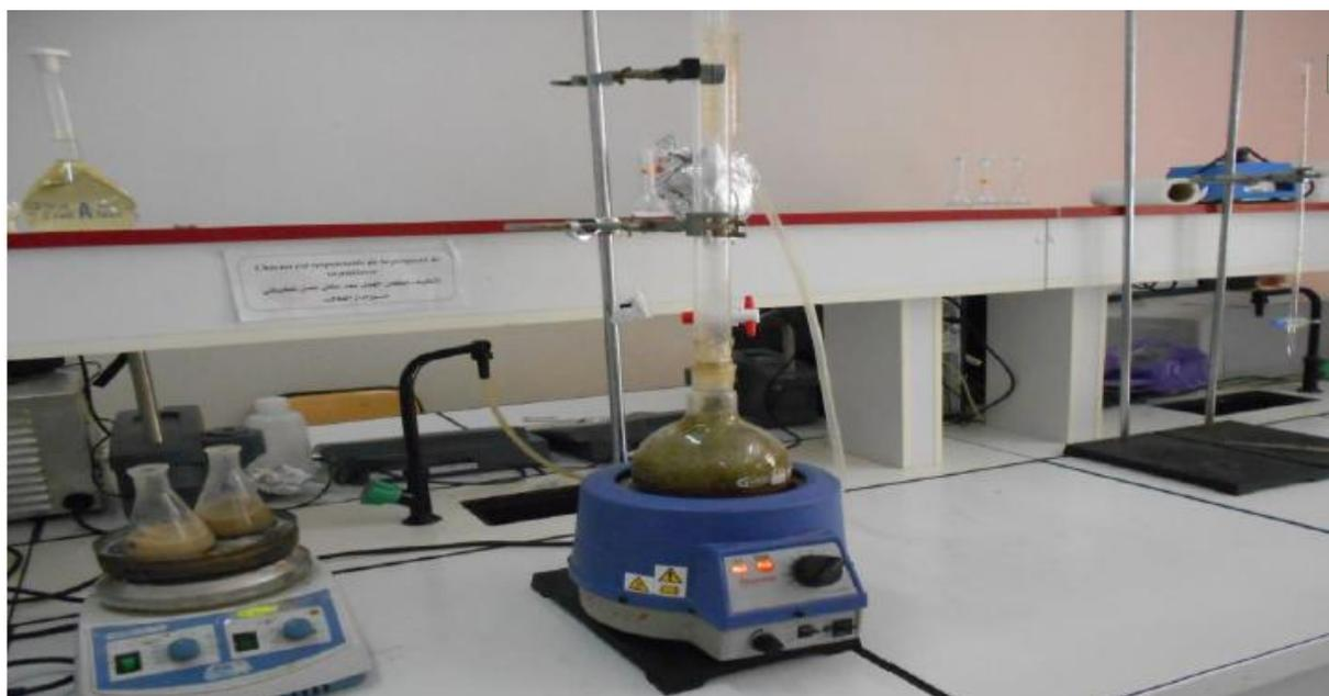
**Figure 10.** Montage de dispositif de l'hydro distillation.
