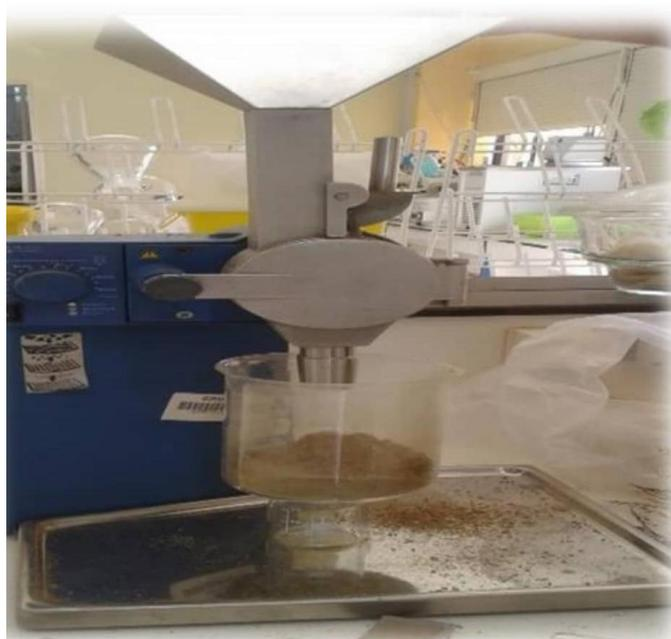
**Figure 4.** Broyage de la plante *Artemisia judiaca* par l'appareille micro-broyeur (Belmont, 2013).
