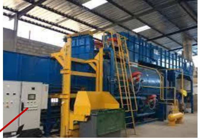
الشكل رقم (2-40): محرقة للنفايات الطبية من نوع اتي مولر HP750 المصدر: إعداد الطالبة
