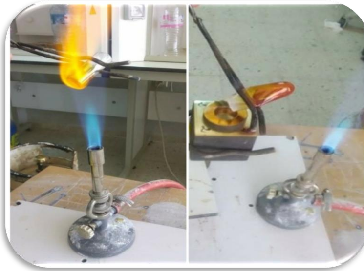
الشكل(II-9): طريقة تسخين والتبريد السريع.
