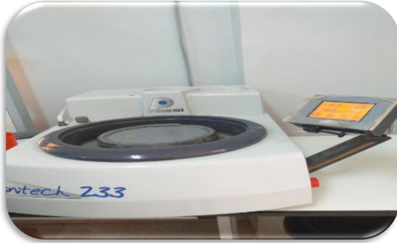
الشكل (II-10): طريقة الصقل.
