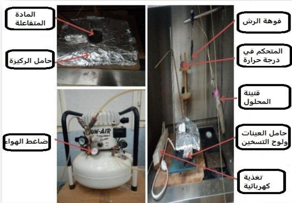
الشكل (1-III) : صورة من العداد التجريبي للرش بالهواء المضغوط.
