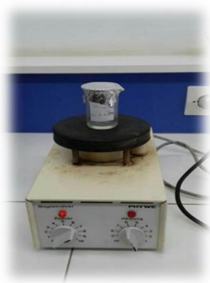
شكل (4.2): صور تحضير محلول المورث (وزن + خلط)
