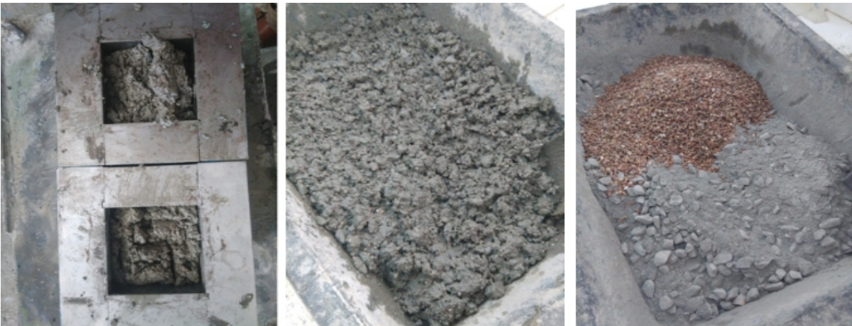
Figure 48. Mise en œuvre des bétons composites TESC-S
