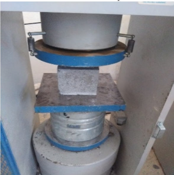
Figure 41. Essais en compression sur échantillon cubique
