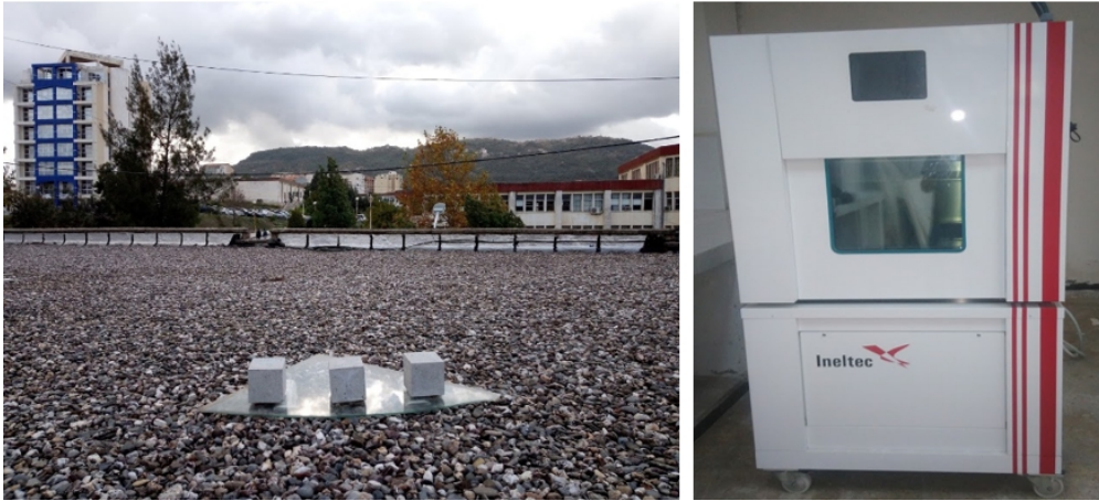
Figure 53. Échantillons du TESC-S25-b exposés aux conditions climatiques naturelles et placés en enceinte climatique (de gauche à droite)
