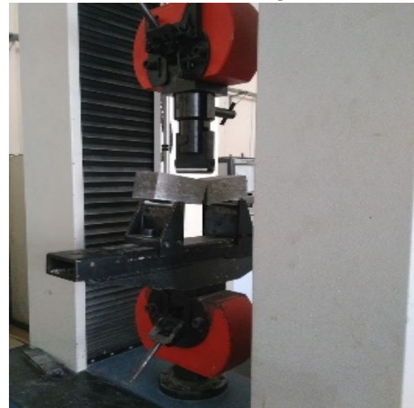
Figure 42. Essais en flexion sur échantillon parallélépipédique
