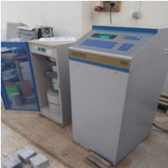
Figure 39. Essais en compression sur échantillons cubiques
