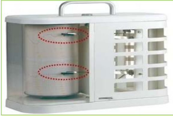
Figure III.31: Les deux aiguilles qui inscrivent les températures et les humidités relatives. [ https://thiesclima.com/ ]
