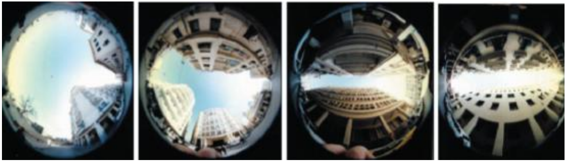
Figure IV.48: Photos Fish-eye prises au niveau des quatre stations respectivement de gauche à droite : (1) espace ouvert, (2) espace semi ouvert, (3) et (4) espaces de type Canyon
