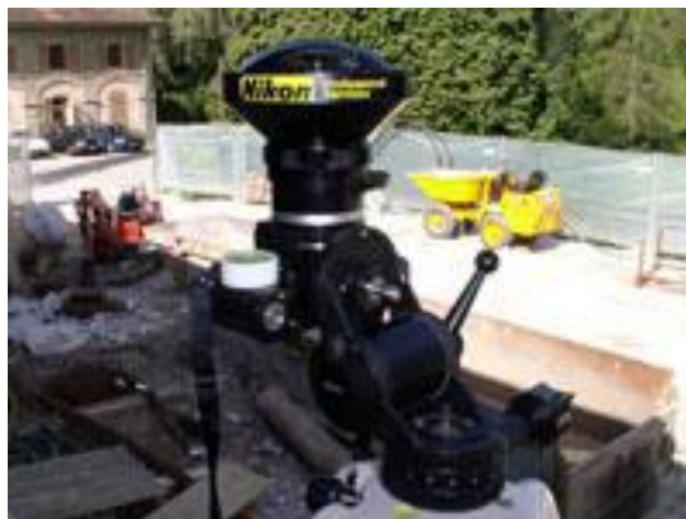
Figure IV.42: Caméra de champ de vision hémisphérique pour l'estimation du facteur de vue de ciel (source : Ben Messaoud, 2010)
