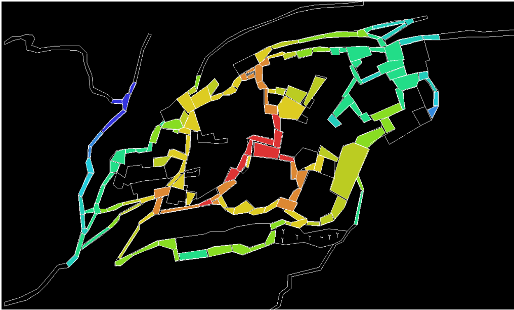
FIGURE 33 : CARTE CONVEXE DU VILLAGE DE GHEZAL MONTRANT LA VALEUR DE L'INTEGRATION ; SOURCE : AUTEUR.
