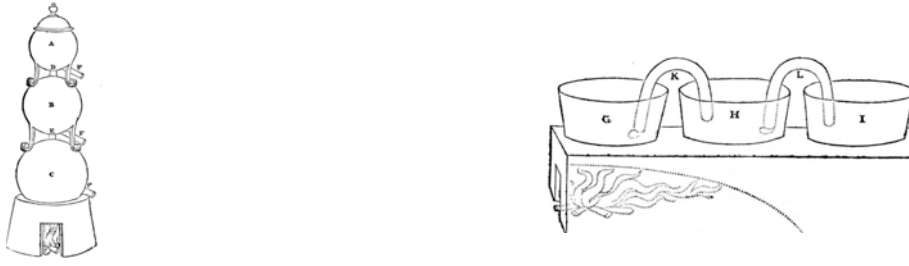
Fig. n°03, Trois vases contenant des eaux chaudes, tièdes et froides pour être conduites par des tuyaux dans les salles de bains, dessins de Claude Perrault, (Vitruve, éd.1684)
