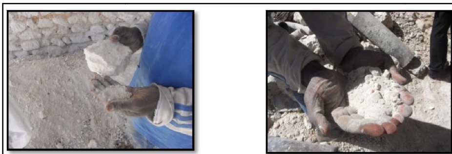
Figures 5.13 : Pierre cuite séchée, poudre de timchemt obtenue (Source : Auteur, 2014)
