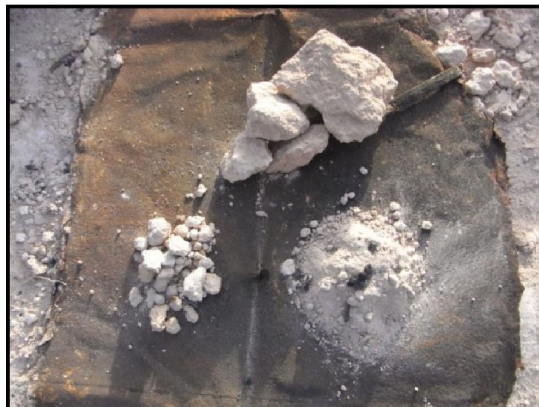
Figure 5.7 : Pierre cuite et produit obtenu « timchemt » du four de Bour El Haicha (Source : Auteur, 2015)
