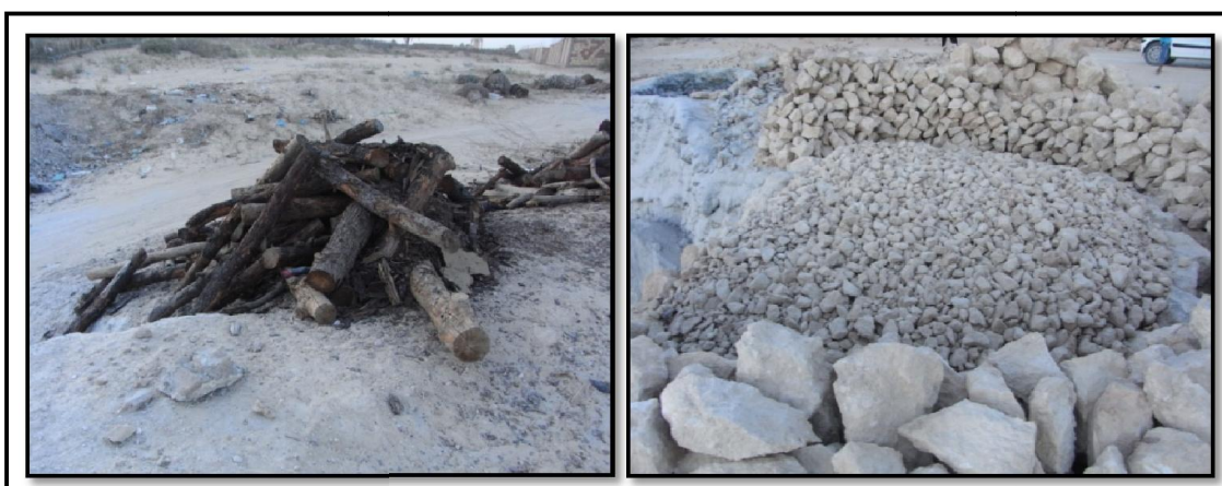
Figures 6.6, 6.7: Amas de bois de cuisson et tri en trois gabarits de tafza en attente devant le four déjà rempli (la forme d'empilement autour du four canalise la fumée vers le haut). (Source : Auteur, 2015)
