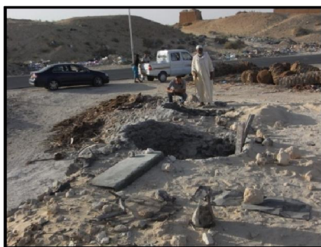
Figure 6.11 : Four à usage complémentaire creusé dans le sol (Source : Auteur, 2015)
