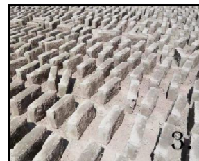
Figure 1.17: Préparation et confection de l'adobe pour la construction.. (Source : Boissard et al, 2008, p .9)
