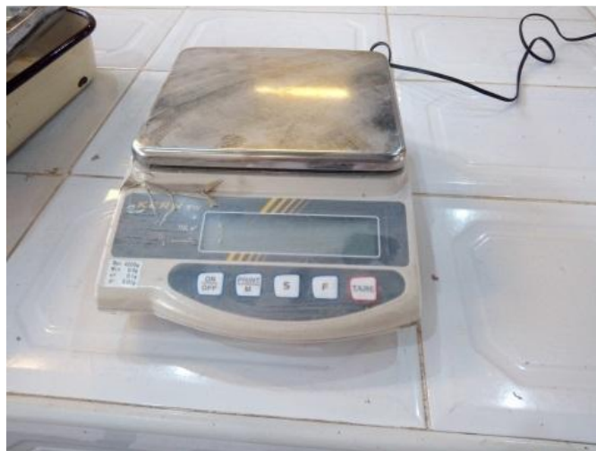
Figure II.9 Balance d'une capacité de 3 kg et une précision de 0,1 g
