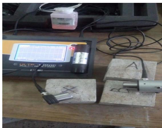
Figure IV.5 Appareillage des essais ultrasoniques
