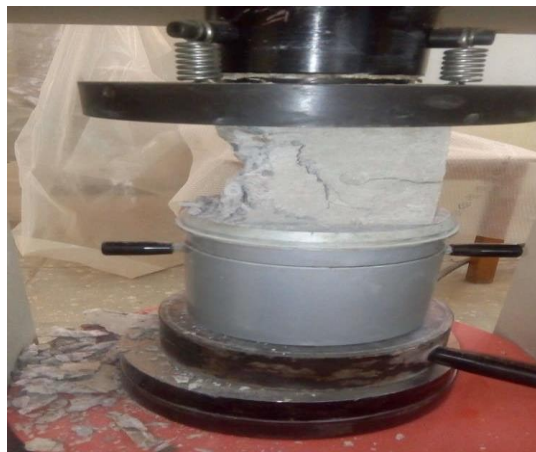
Figure II.5 L'essai de l'écrasement
