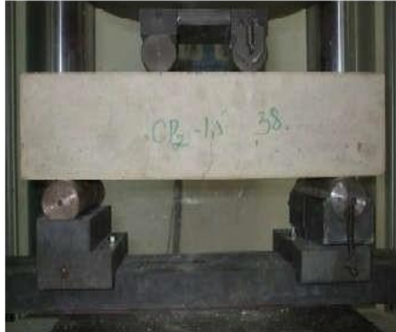
Figure II.6 Essai de traction par flexion
