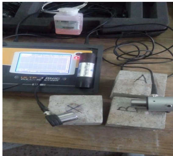
Figure II.7 Appareillage de l'essai de l'ultrason
