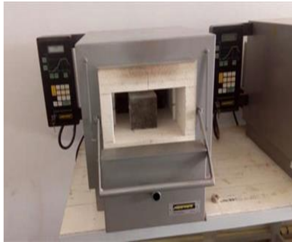
Figure II.4 Dispositif de chauffage des éprouvettes
