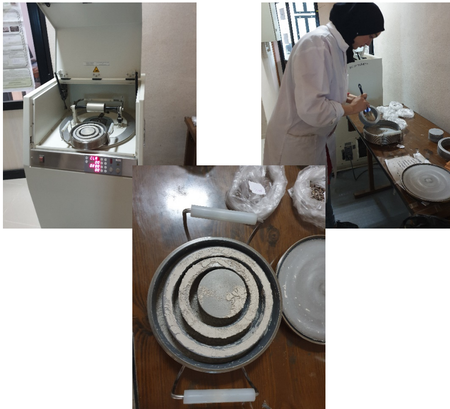
Figure III.18. Vibrobroyeur à disque et sa garniture.
