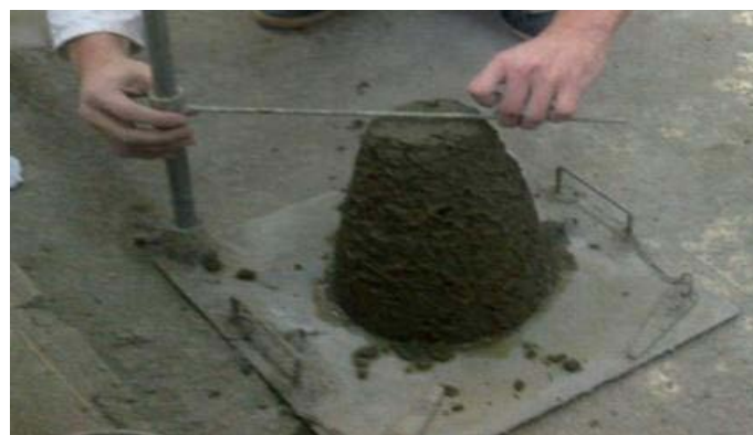
Figure III.15. Essai d'ouvrabilité au cône d'Abrams.
