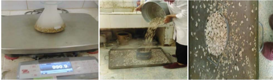
Figure III.7. Essai de la masse volumique apparente et absolue du gravier
