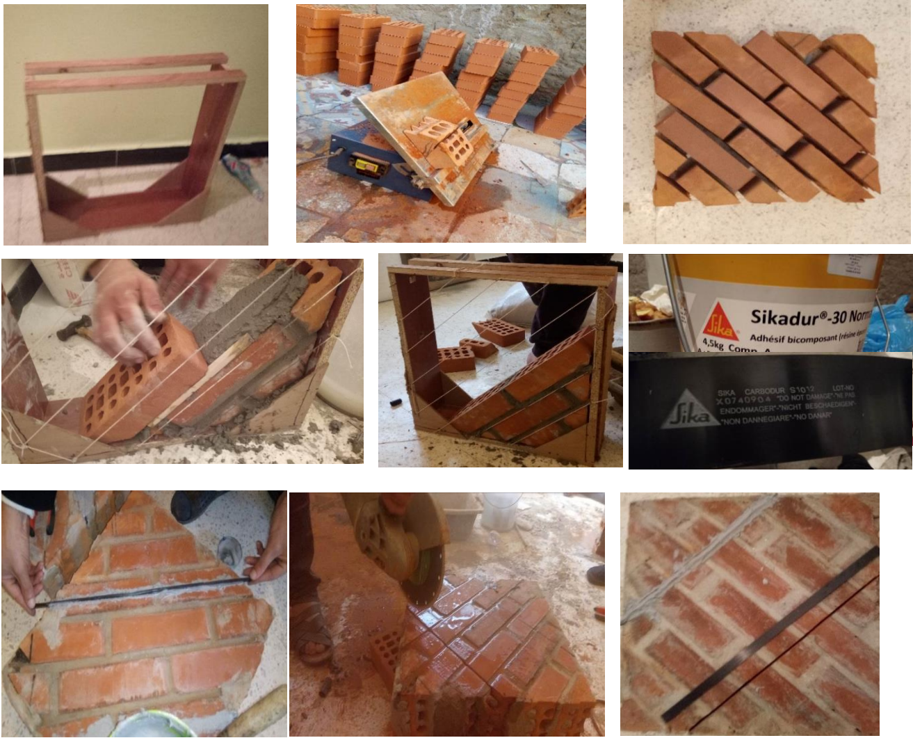
(d) fabrication of specimens and installation of CFRP
