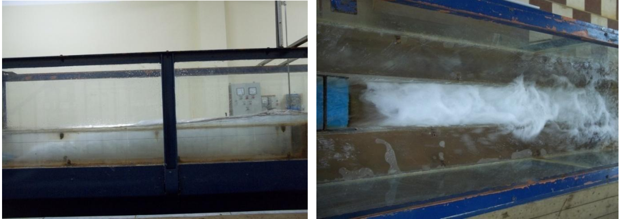
Photo I.14: Photographie d'un ressaut hydraulique contrôlé par seuil épais F_1 = 8,33 ; s = 15 cm; L_j = 183 cm; h_2 = 25,2 cm ; h_1 = 2,5 cm
