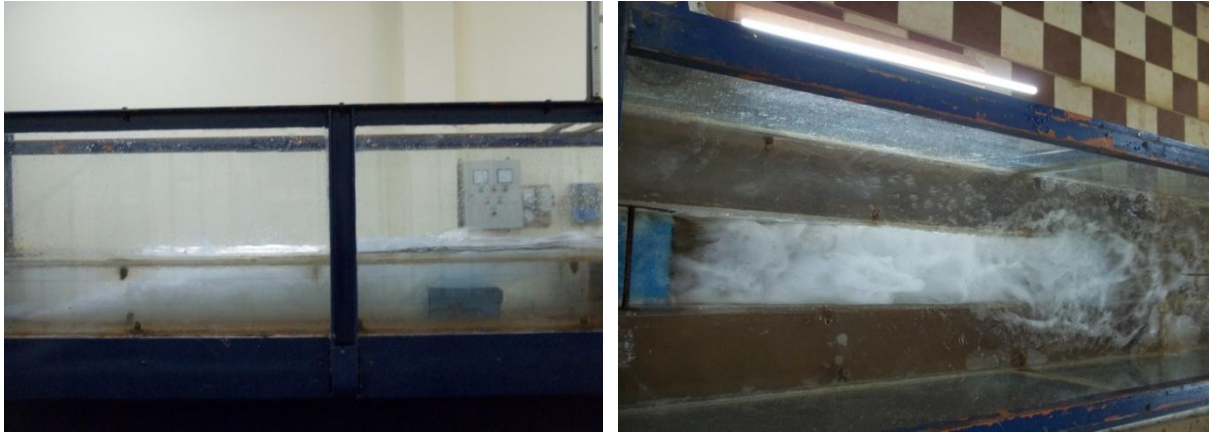
Photo II.6 : Photographie d'un ressaut hydraulique forcé par seuil épais F_1 = 8,38 ; s = 10,9 cm; L_s = 115 cm; h_2 = 23,4 cm ; h_1 = 2,5 cm
