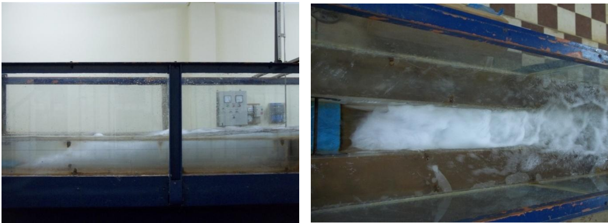
Photo I.11 : Photographie d'un ressaut hydraulique contrôlé par seuil mince F_1 = 8,24 ; s = 15 cm; L_j = 186 cm; h_2 = 24,9 cm ; h_1 = 2,5 cm
