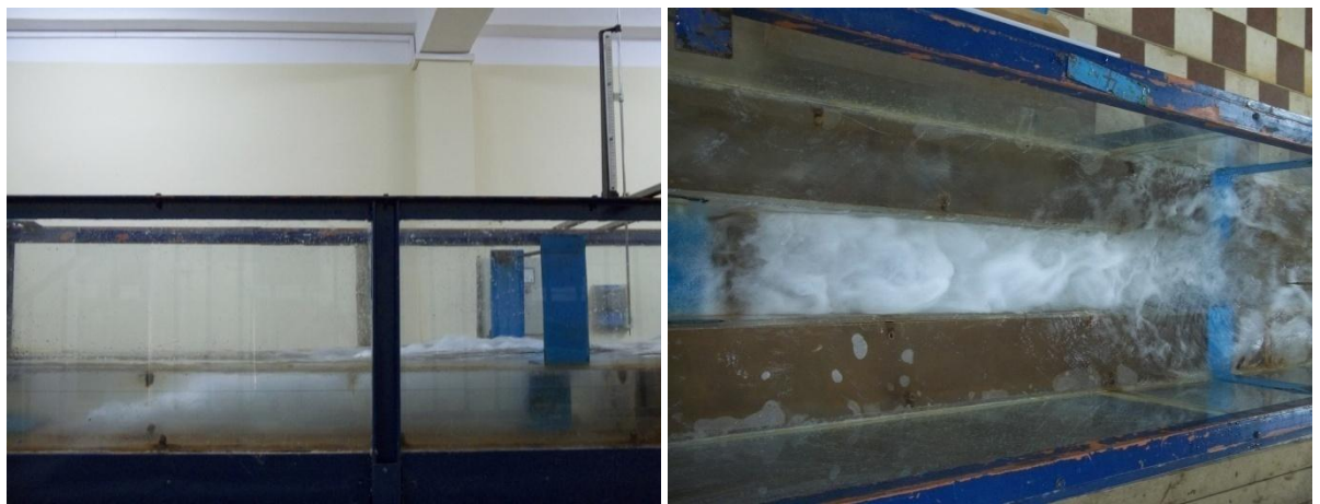
Photo II.2 : Photographie d'un ressaut hydraulique forcé par seuil mince type A F_1 = 8, 38 ; s = 11 cm; L_B = 171 cm; h_2 = 23,5 cm ; h_1 = 2,5 cm
