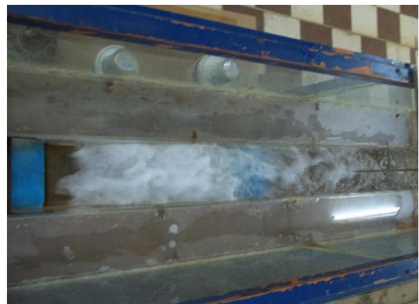
Photo II.5 : Photographie d'un ressaut hydraulique forcé par seuil épais F_1 = 5,99 ; s = 4,5 cm; L_s = 58 cm; h_2 = 15,7 cm; h_1 = 2,5 cm
