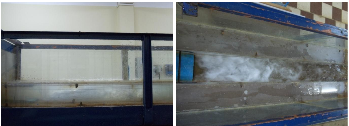
Photo I. 16 : Photographie d'un ressaut hydraulique contrôlé par marche positive F_1 = 5,504 ; s = 5,4 cm; L_j = 100 cm; h_2 = 15,8 cm ; h_1 = 2,5 cm
