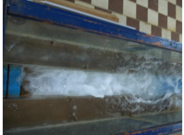
Photo II.8: Photographie d'un ressaut hydraulique forcé par marche positive F_1 = 8,52 ; s = 11,8 cm; L_s = 126 cm; h_2 = 23,1 cm; h_1 = 2,5 cm
