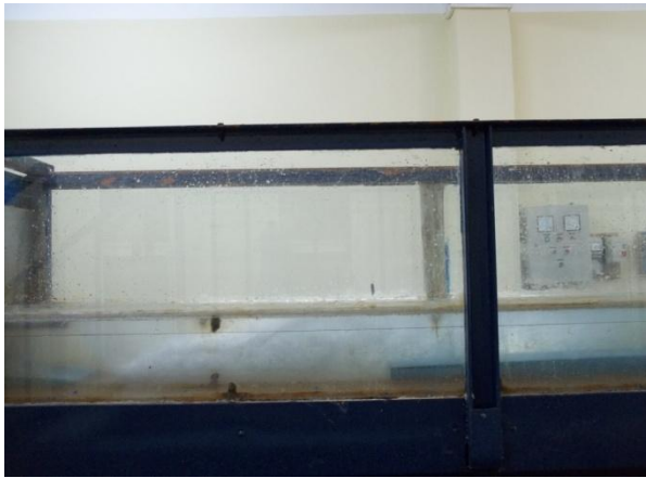
Photo II.7: Photographie d'un ressaut hydraulique forcé par marche positive F_1 = 6,67 ; s = 5,4 cm; L_s = 70 cm; h_2 = 16,9 cm; h_1 = 2,5 cm
