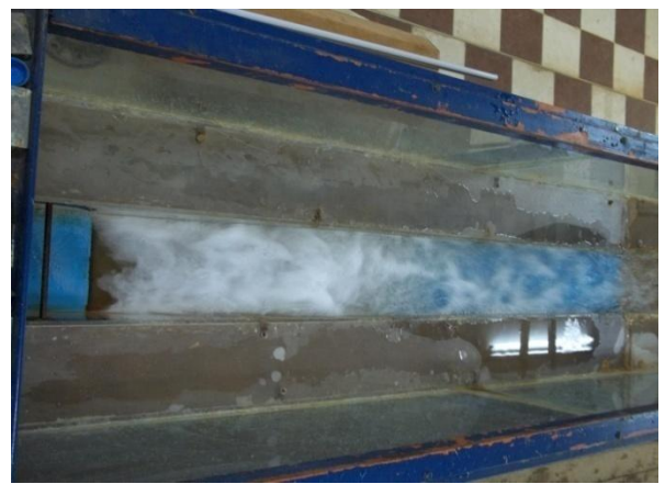
Photo II.7: Photographie d'un ressaut hydraulique forcé par marche positive F_1 = 6,67 ; s = 5,4 cm; L_s = 70 cm; h_2 = 16,9 cm; h_1 = 2,5 cm
