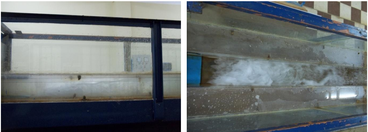
Photo I.13 : Photographie d'un ressaut hydraulique contrôlé par seuil épais F_1 = 5,34 ; s = 5,4 cm; L_j = 102 cm; h_2 = 15,6 cm ; h_1 = 2,5 cm
