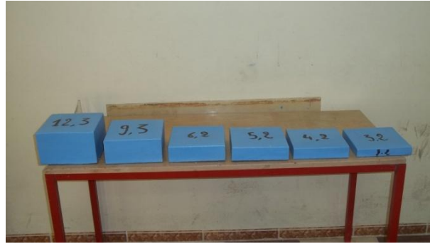
Photo I.12 : Photographie des seuils épais.
