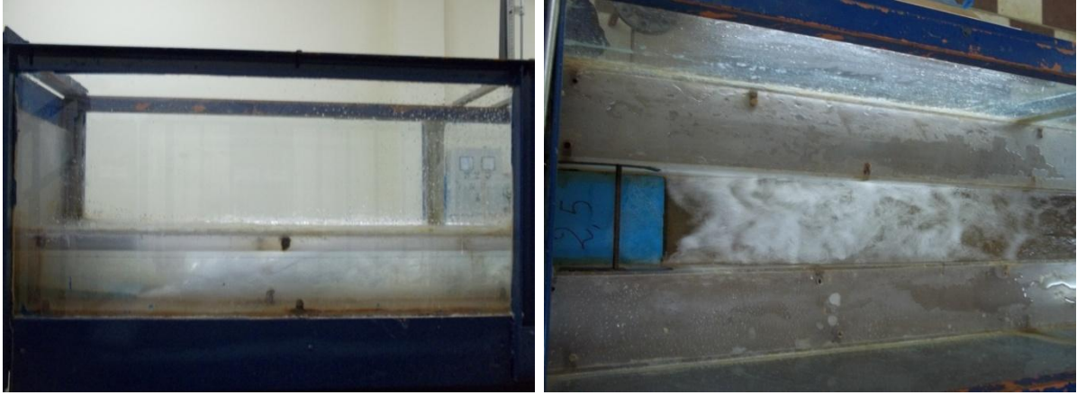
Photo I.10: Photographie d'un ressaut hydraulique contrôlé par seuil mince F_1 = 5,58 ; s = 6 cm; L_j = 103 cm; h_2 = 15,8 cm ; h_1 = 2,5 cm
