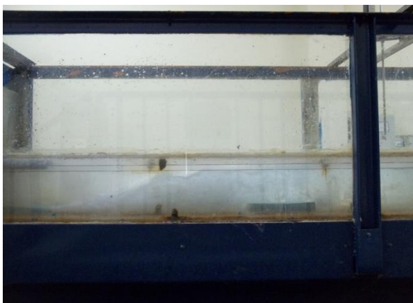
Photo II.5 : Photographie d'un ressaut hydraulique forcé par seuil épais F_1 = 5,99 ; s = 4,5 cm; L_s = 58 cm; h_2 = 15,7 cm; h_1 = 2,5 cm
