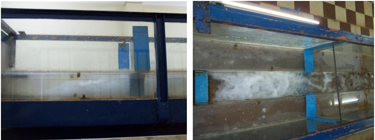
Photos II.1 : Photographie d'un ressaut hydraulique forcé par seuil mince type A F_1 = 6, 16 ; s = 4 cm; L_B = 107 cm; h_2 = 16,3 cm ; h_1 = 2,5 cm
