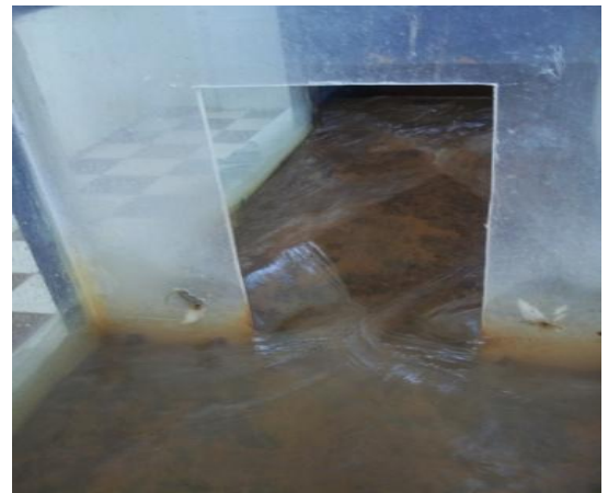
Photo I.7 : Photographie du déversoir rectangulaire.
