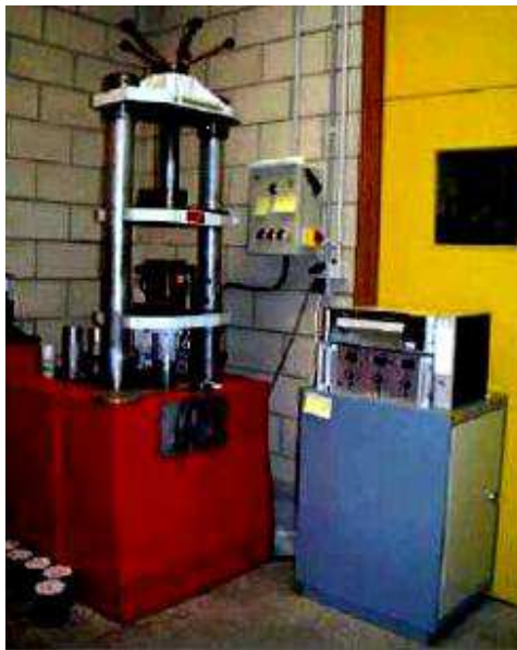
Fig. I.3 : Essai de tenue à l'eau (CETE, 2010).
