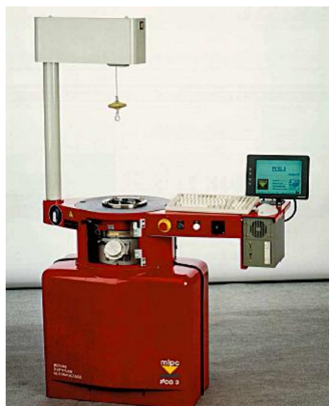
Fig. I.2 : La presse de cisaillement giratoire (CETE, 2010).
