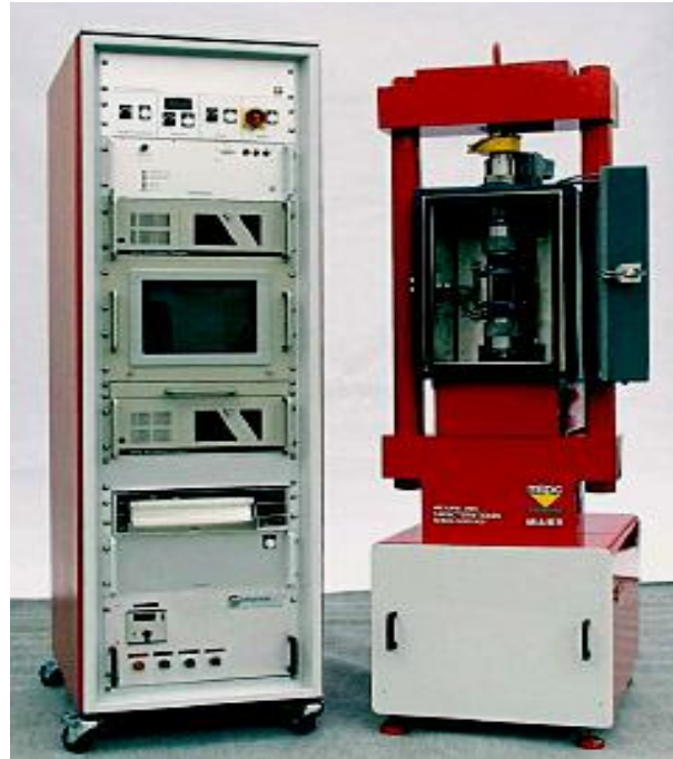
Fig. I.5 : Mesure du module des enrobés bitumineux en traction directe : essai MAER (CETE, 2010).
