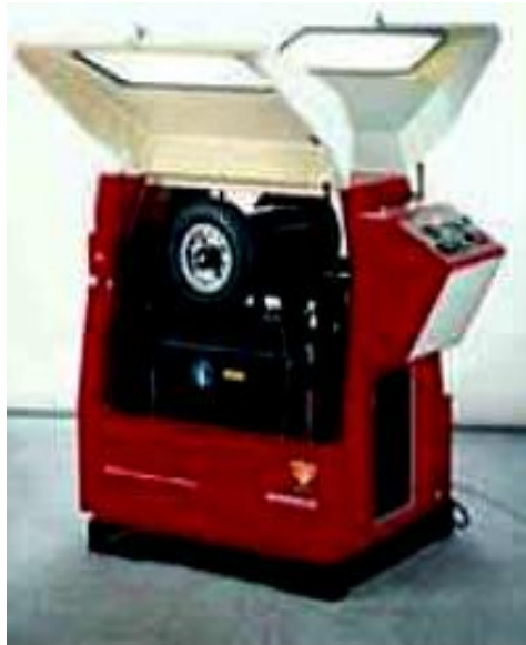
Fig. I.4: Appareil de mesure de la profondeur d'ornièrre (CETE, 2010).
