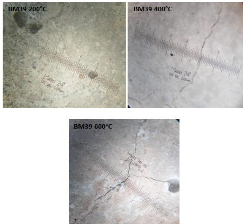
Figure IV.19 Observation microscope optique de béton de fibres métalliques chauffé à 200°, 400°C et 600°C.
