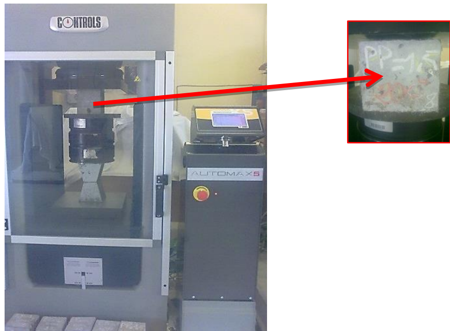
Figure II.12 Mise en place des éprouvettes sur presse hydraulique (La résistance en compression).
