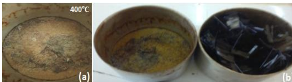
Figure III.19 (a) Échantillon de fibres polypropylène et (b) Échantillon de fibres de carbone après le cycle d'échauffement- refroidissement à la température 400°C.
