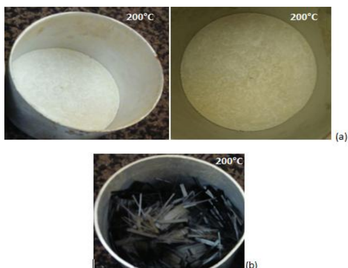
Figure III.17 (a) Échantillon de fibres polypropylène et (b) Échantillon de fibres de carbone après le cycle d'échauffement- refroidissement à la température 200°C.
