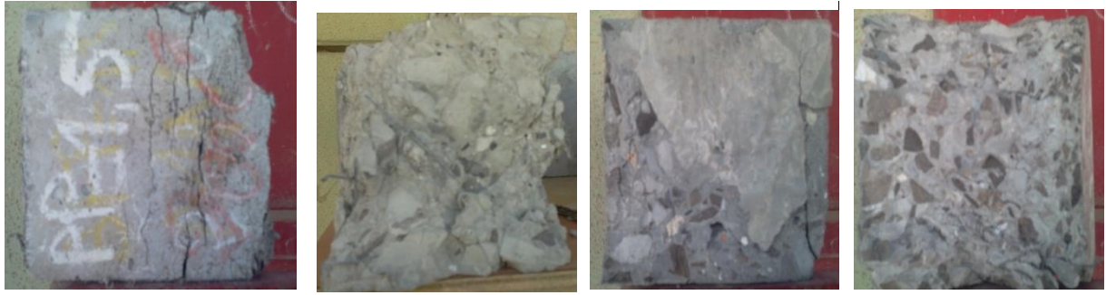
Figure IV.15 Observation visuel de béton après essais d'écrasement des éprouvette pour béton de fibres polypropylène, béton de fibres métalliques , béton de fibres de carbone et béton sans fibres après les cycles de chauffage-refroidissement à 200°C.
