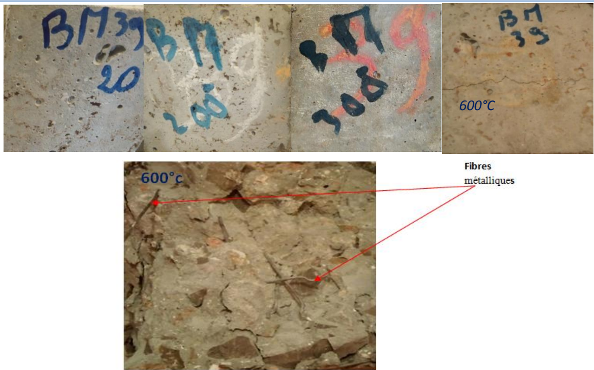
Figure IV. 11 Observation visuelle de béton de fibres métalliques à la température ambiante et après les cycles de chauffage-refroidissement à 200°C et 300°C, et 600°C
