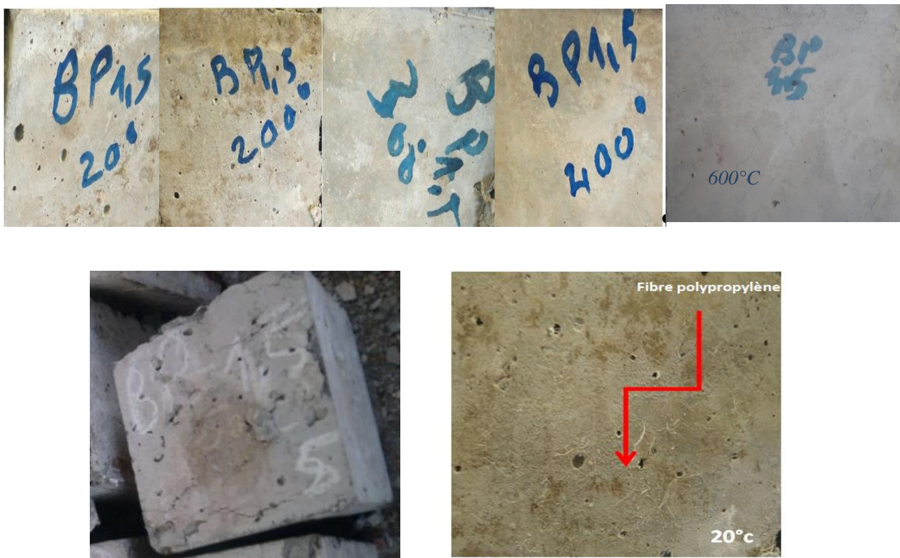
Figure IV. 11 Observation visuelle de béton de fibres métalliques à la température ambiante et après les cycles de chauffage-refroidissement à 200°C et 300°C, et 600°C
