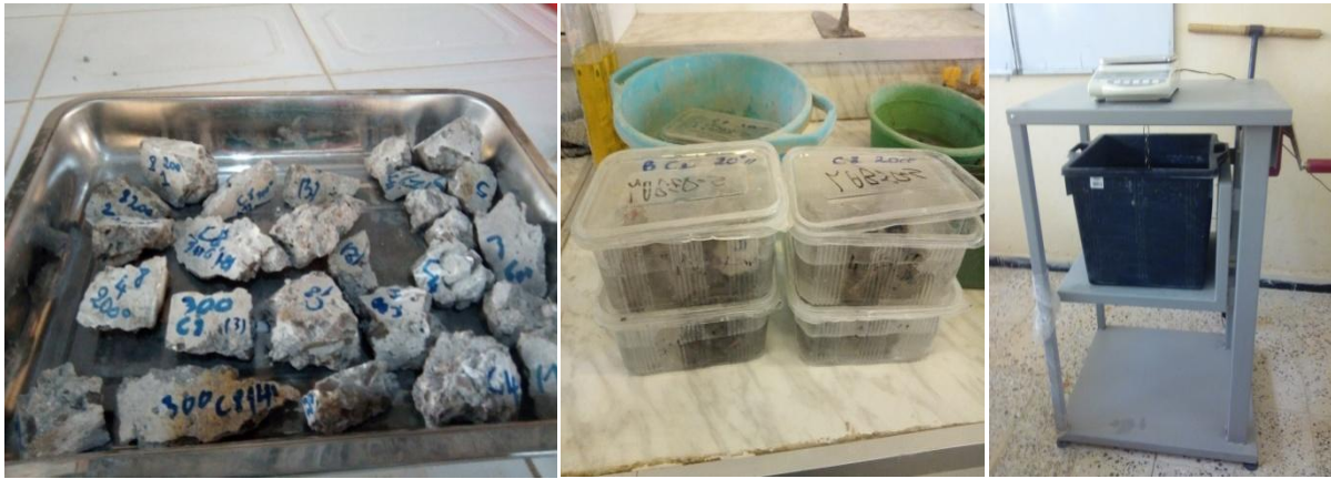
Figure II.15 Echantillons utilisés pour la détermination de la porosité à l'eau et dispositif de la pesée hydrostatique.
