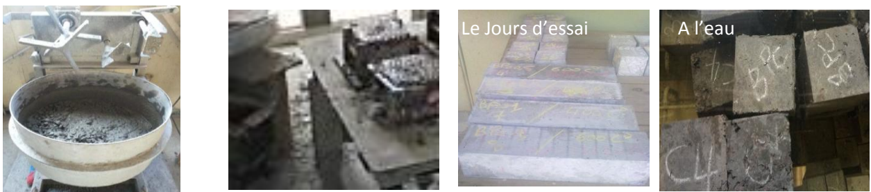
Figure II.9 a) Mélange des constituants b) Remplissage des moules c) Conservation des éprouvettes
