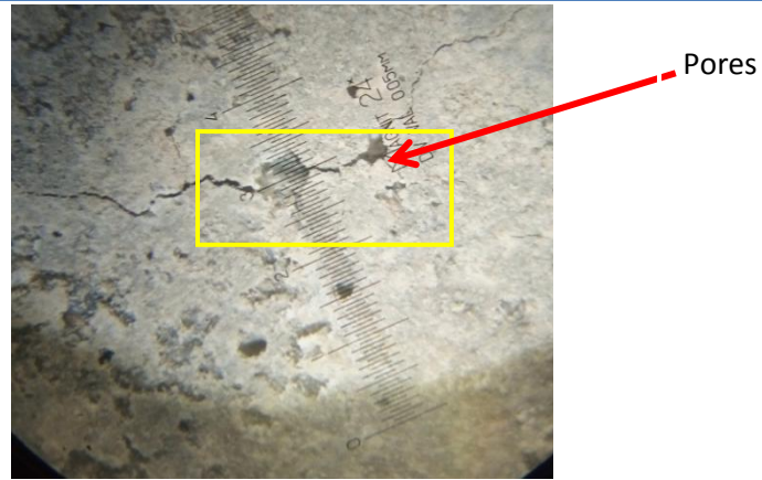
Figure IV.24 Développement des fissures à la surface autour des pores des éprouvettes en béton après traitement thermique à 600°C.
