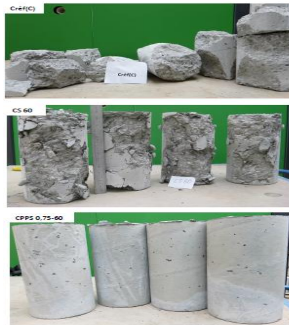
Figure I.28 Éprouvettes cylindriques après chauffage à 10°C/min jusqu'à 600°C pour : a) béton sans fibres- b) béton avec 60 Kg de fibres métalliques - c) béton avec un cocktail 0,75kg fibres polypropylènes et 60 Kg de fibres métalliques [Yermak, 2015]
