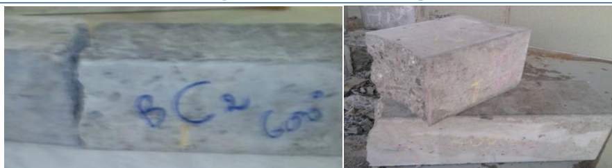
Figure IV.3 Des éprouvettes de bétons avec 1) fibres métalliques 2) mélange fibres métalliques et carbone 3) béton avec fibre de carbone et béton sans fibres après essai de flexion.
