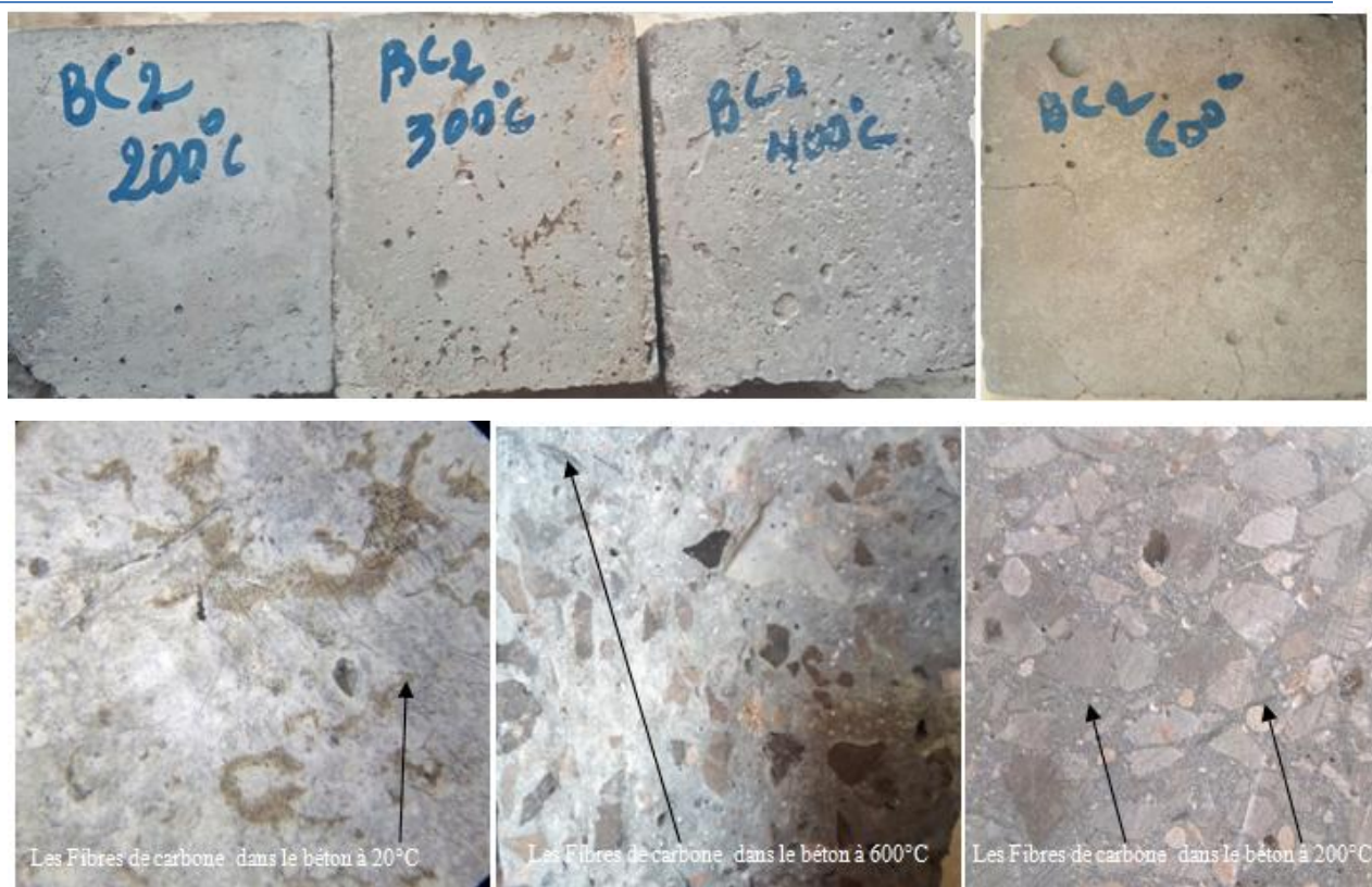
Figure IV.13 Observation visuel de béton de fibres carbone C2 à la température ambiante et après les cycles de chauffage-refroidissement à 200°C, et 600°C
