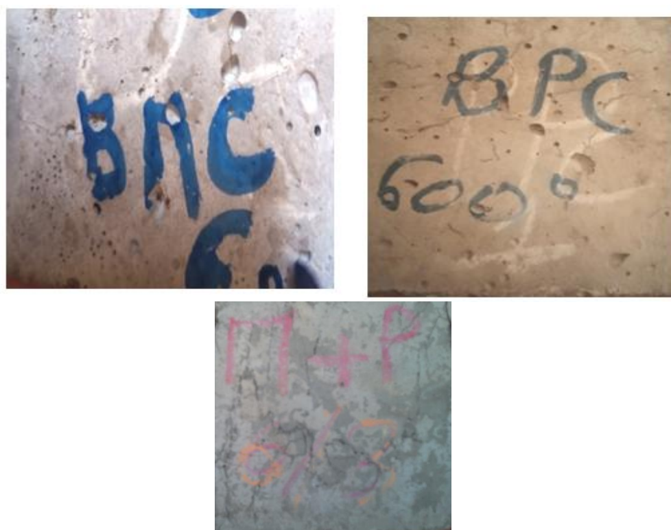
Figure IV.14 Observation visuelle de béton de mélange de fibres à la température 600°C (BMC, BPC, BMP) respectivement après les cycles de chauffage-refroidissement.
