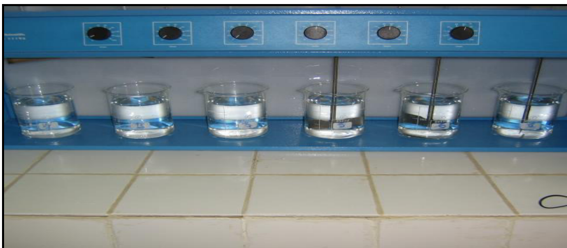
Figure 22 : Flocculateur de laboratoire utilisé pour les essais de coagulation-floculation.
