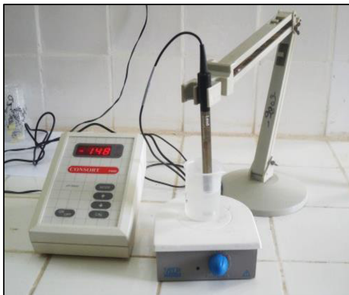
Figure 17: Appareillage utilisé pour le dosage du plomb dans les échantillons d'eau.
