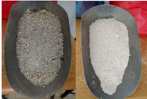
Photo 3-6: Laitier avant et après broyage
