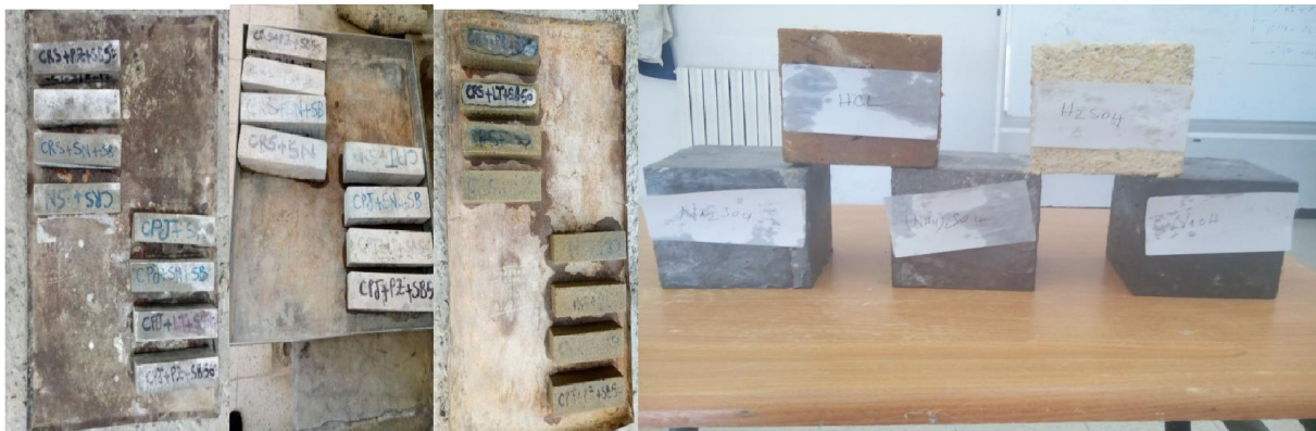
Photo 3-21: Conservation des éprouvettes dans des milieux agressifs
