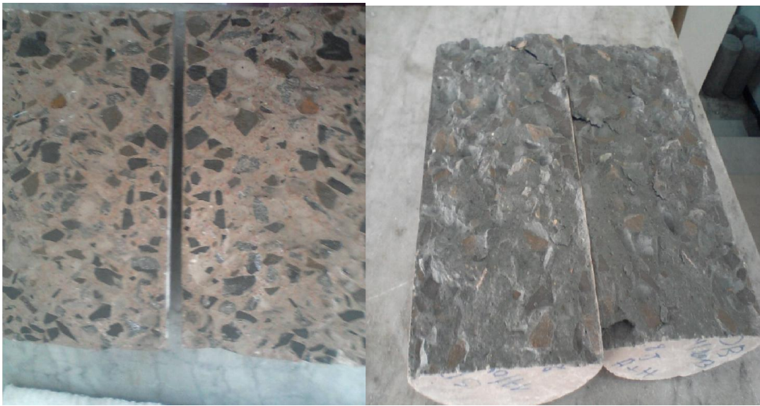
Photo 3-19: Ecrasement d'une éprouvette cylindrique (16 \times 32) \text{ cm}^3
