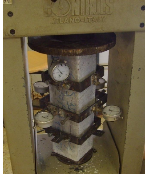
Photos 4-2: Essai de déformabilité sur éprouvette prismatique (10×10×40) cm 3
