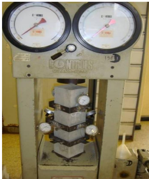
Photo 3-22 : Essai de déformabilité sur éprouvette prismatique (10\times 10\times 40)\text{ cm}^3
