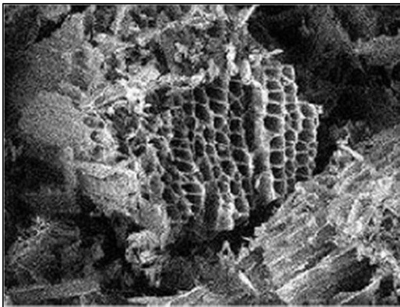
Figure 17 : Image sous un microscope électronique d'un charbon actif ( Omlin et al, 2010 )
