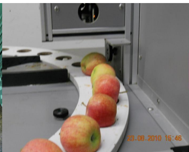
Figure IV. 2. Mesure des paramètres physico-chimiques des pommes (Gala) à l'aide de l'automate (Robot Pimprenelle, Setop-Giraud Setop Giraud Technology, France).
