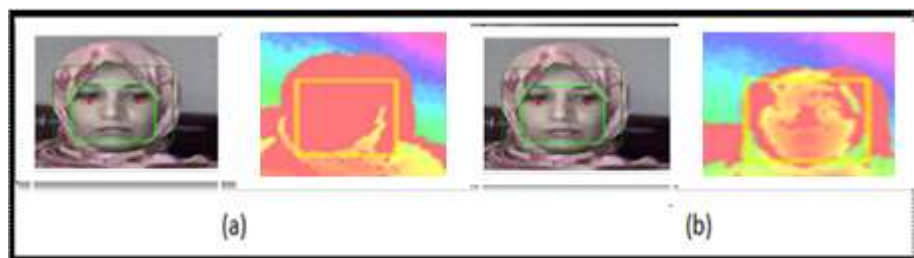
Figure 5.5. Alignement des deux flux caméra : (a) visualise les deux flux avant l'appel de la fonction SetViewPoint() et (b) visualise l'effet de la fonction.
