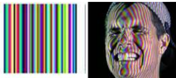
Figure 1.13. La projection d'une lumière structurée sur un visage.
