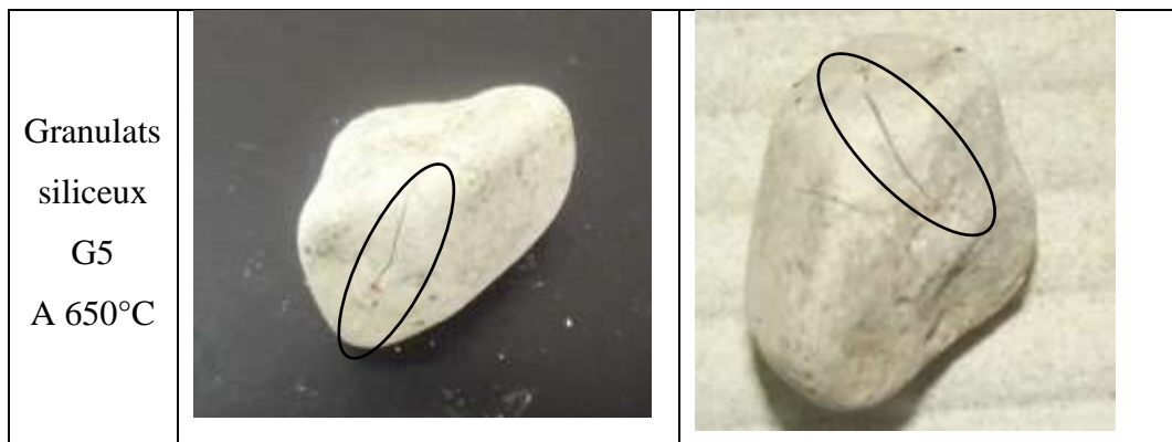
Figure IX. 2: Observation de la fissuration des granulats siliceux chauffés à 650°C.
