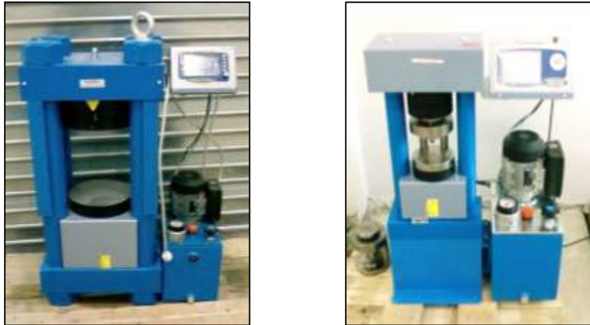
Figure IV. 7: Dispositif de mesure des propriétés mécaniques en compressions
