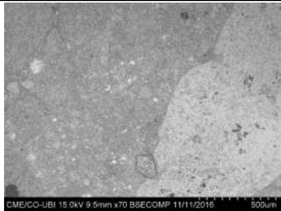
Figure IX. 24 : Images MEB correspondant à béton G5 a 400 °C Cartographies X montrent les répartitions de Si, Ca, Fe, Mg et Al dans le béton G5 Identification EDS et spectres correspondant à béton G5
