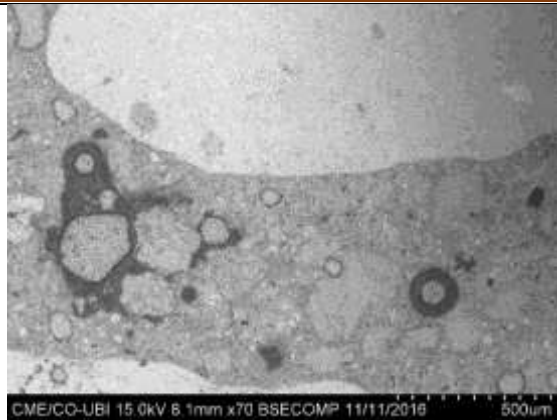
Figure IX. 19 : Images MEB correspondant à béton G5 a 25 °C (avant chauffage) Cartographies X montrent les répartitions de Si, Ca, Fe, Mg et Al dans le béton G5 Identification EDS et spectres correspondant à béton G5
