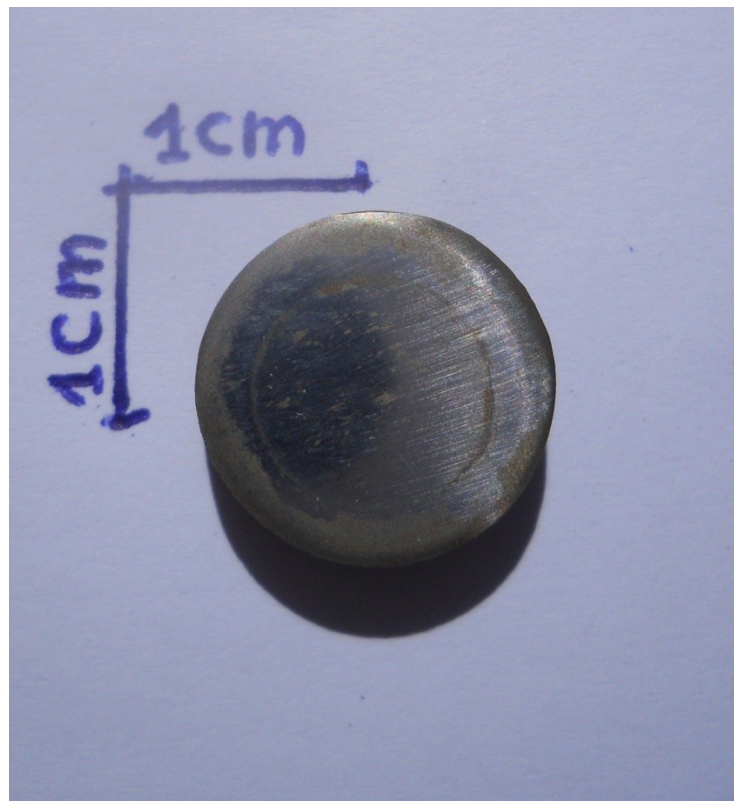
Fig. II.6: L'échantillon préparé pour le test de polarisation.
