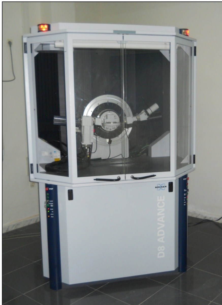
Fig. II.13: Diffractomètre de rayons X (BRUKER D8 ADVANCE).
