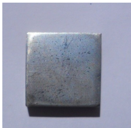
Fig. II.2: L'échantillon préparé pour le microscope optique.
