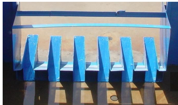
Figure 1.11. Déversoir en touches de piano type A.
