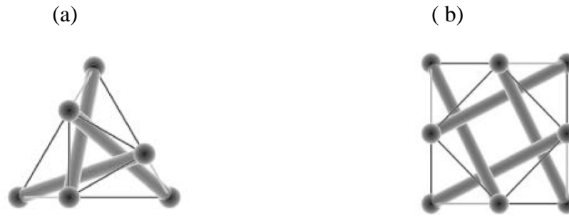
Fig. 1.13 Cellules de Tenségrité; a : Simplex à 3 barres et 9 câbles, b : Quadruplex à 4 barres et 12 câbles. [QUI00],
