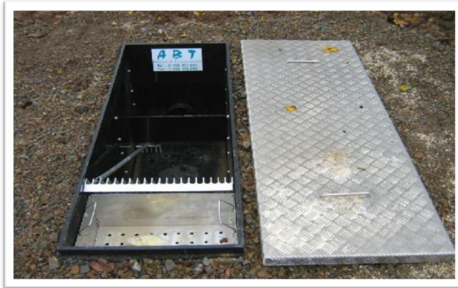
Figure 3.3. Photo d'un dégrilleur manuel (DADDH, 2012).
