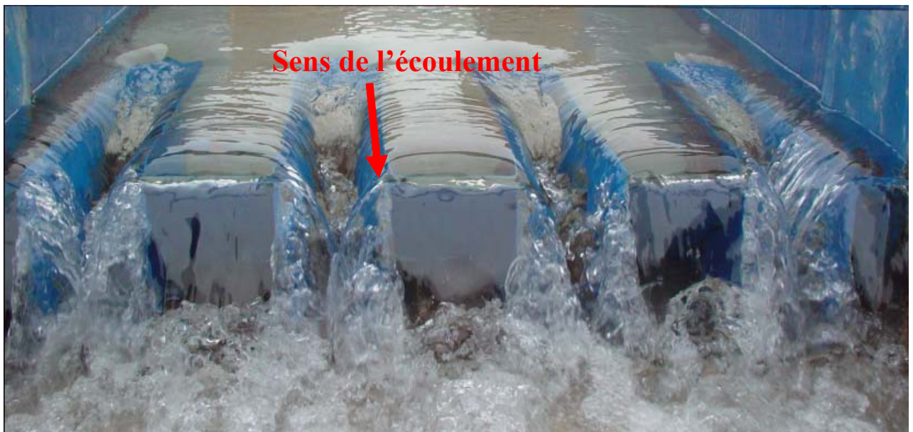
Figure (III-3): Photo du plan d'eau à l'entrée du PK-Weir pour un faible débit ( Q = 47 l/s)
