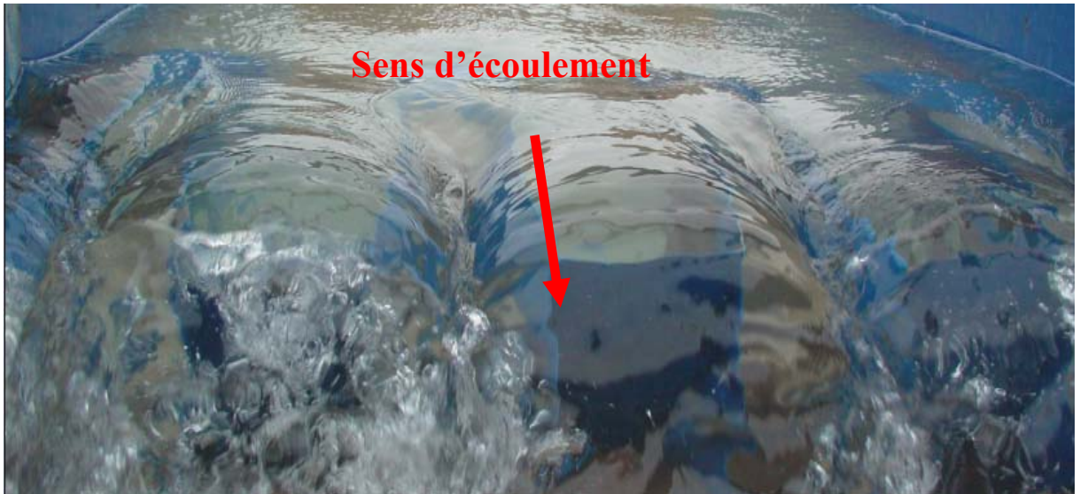
Figure III-5 Photo du plan d'eau à l'entrée du PK-Weir pour un débit moyen ( Q = 103 l/s)
