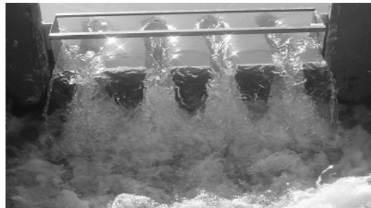
Figure III-4 Ecoulement en deux nappes déversant sur un cycle de PK-Weir (Ouamane [13] b).
