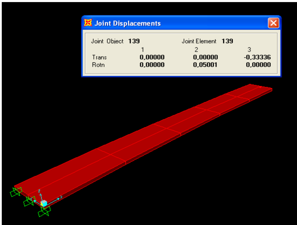
(Figure. V.9) : Présentation graphique par SAP 2000 V14 d'une console sous charge concentrée ( \frac{L}{h} = 1 à 100, P = 0.1 , \nu = 0.3 , E = 1.2 \times 10^6 )
