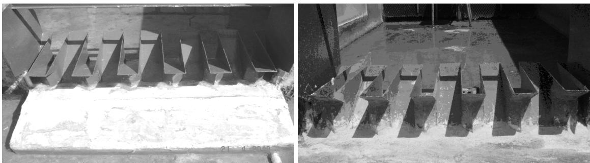
Figure II.05 : PK-Weir sur socle arrondi en amont. Figure II.06 : PK-Weir placé sur le radier du canal
