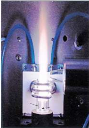
Figure I.4: Torche à plasma inductif à tube de quartz
