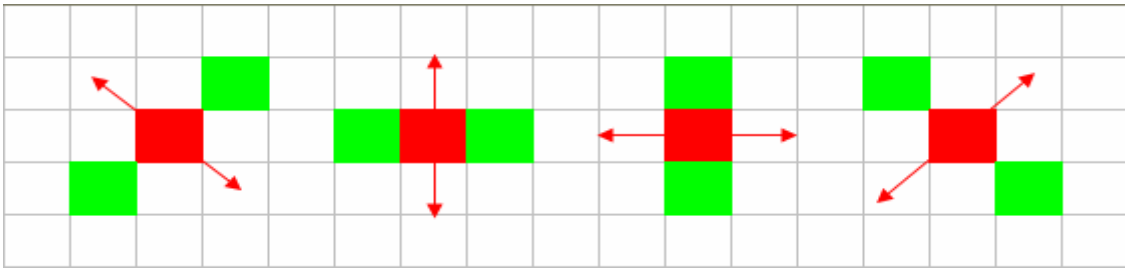
Figure 45 : Alignement des membres de groupe (vert) suite au mouvement de leur chef (rouge)
