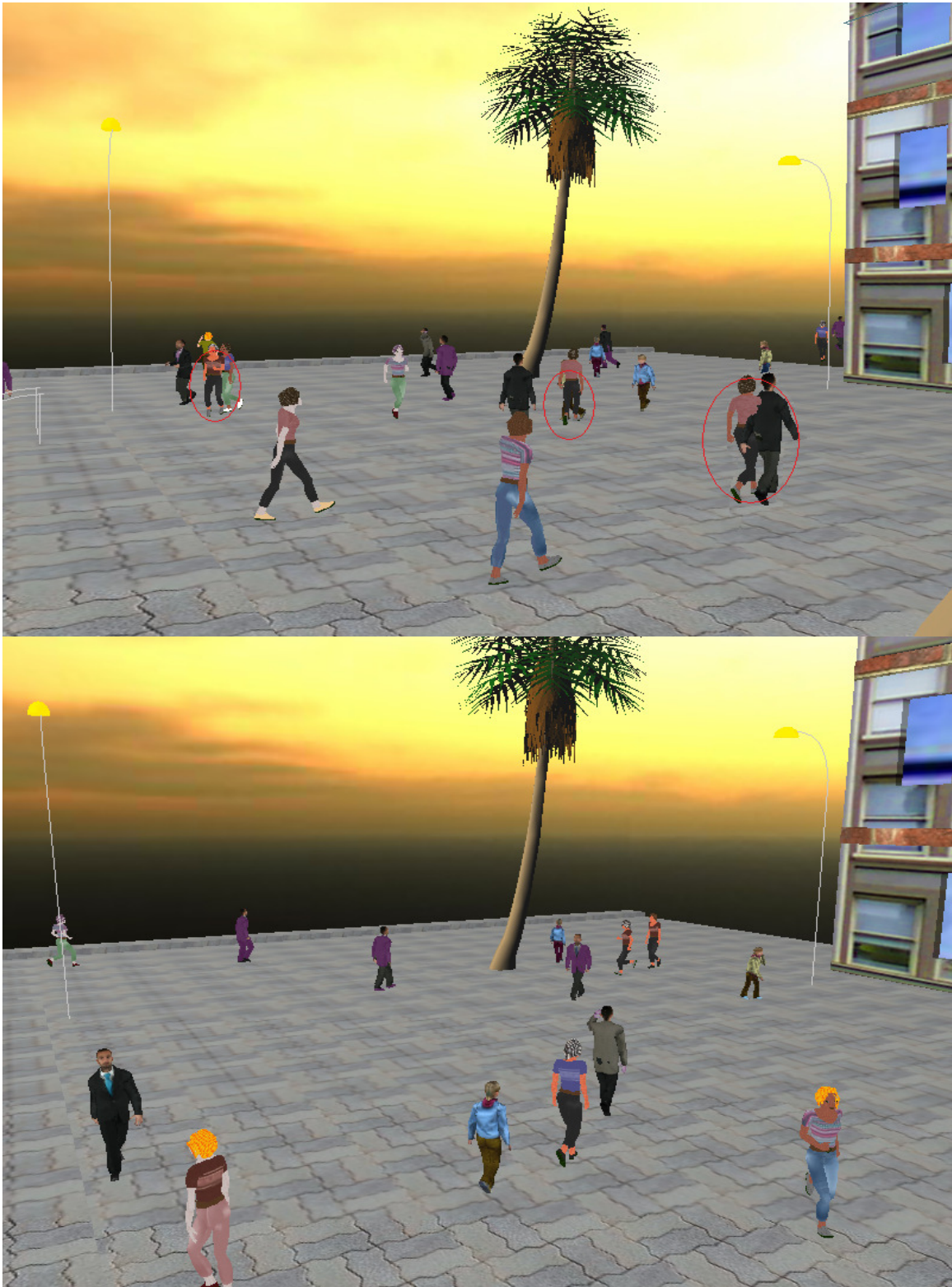
Figure 56 : En haut, l'évitement de collision est désactivé, de nombreuses collisions se produisent (cercle rouge). En bas, il est activé, la simulation est plus réaliste.
