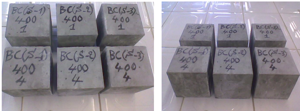
Photo 4-2 : Eprouvettes cubiques (10x10x10) cm 3 .
