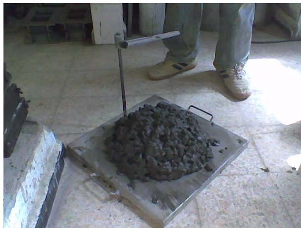
Photo 4-1 : Essai du Slump-test.
