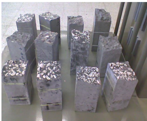
Photo 4-4 : Eprouvettes prismatiques (10x10x40) cm 3 .
