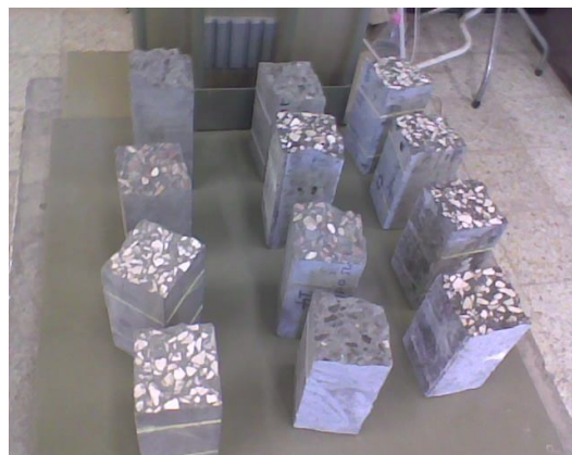
Photo 4-4 : Eprouvettes prismatiques (10x10x40) cm 3 .
