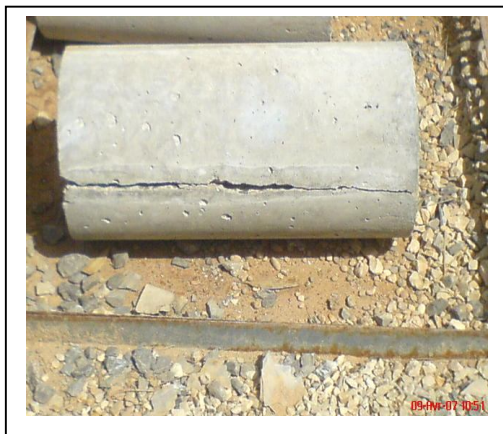
Photo 5-2 : rupture des éprouvettes « l'essai brésilien ».
