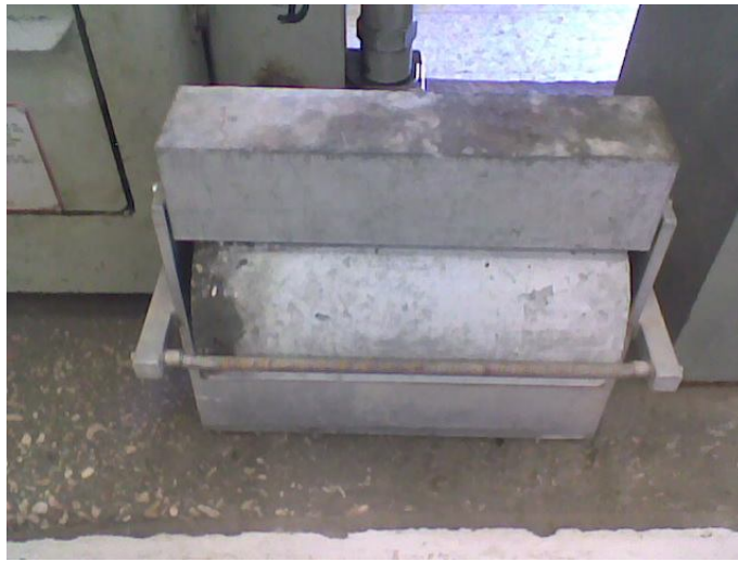
Photo 4-3 : Eprouvettes cylindriques (16x32) cm 2 .
