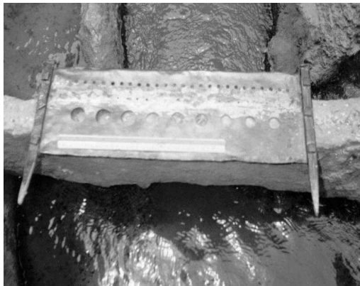
Fig. II.1. Plaques de jaugeage dans la région de Timimoun (Remini B., 2007)
