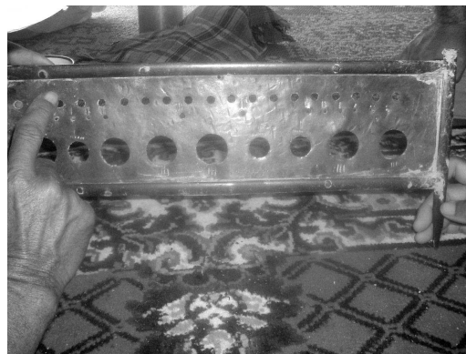
Fig. II.1. Plaques de jaugeage dans la région de Timimoun (Remini B., 2007)
