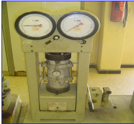
Phot. 3.13- Dispositif pour mesurer le module élastique.
