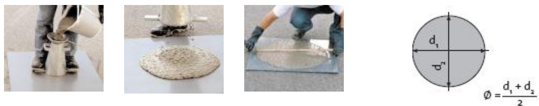
Phot. 2.3 - Détermination de l'étalement. [24]
