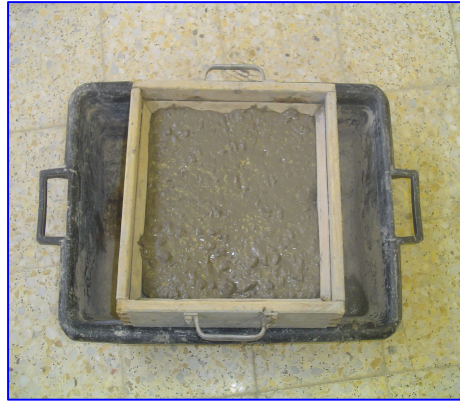
Phot. 3.10- Essai de stabilité au tamis. [40]
