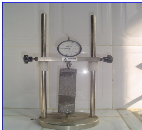
Phot. 3.14- Dispositif pour mesurer le retrait.
