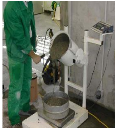
Phot. 2.5 - Dispositif de l'essai de stabilité au tamis.[40]
