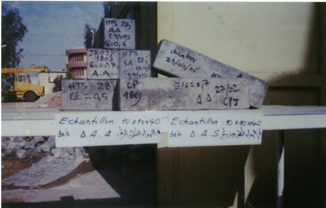
Figure (25) : échantillons de béton prismatiques et cubiques durcis à l'air libre avec et sans arrosage
