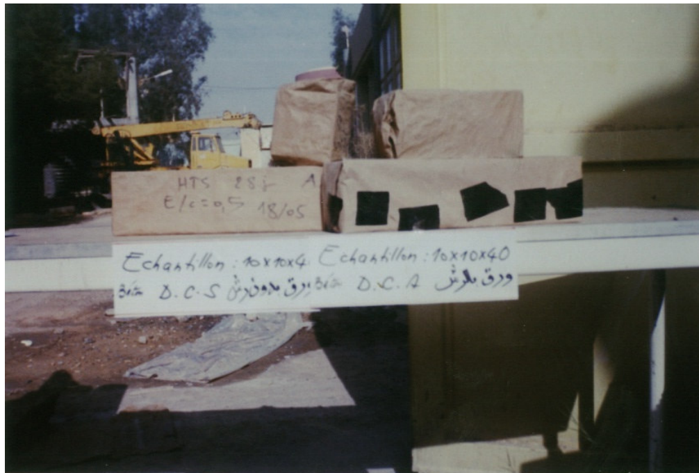
Figure (20) : Bétons durcis au carton avec et sans arrosage Cubiques et prismatiques
