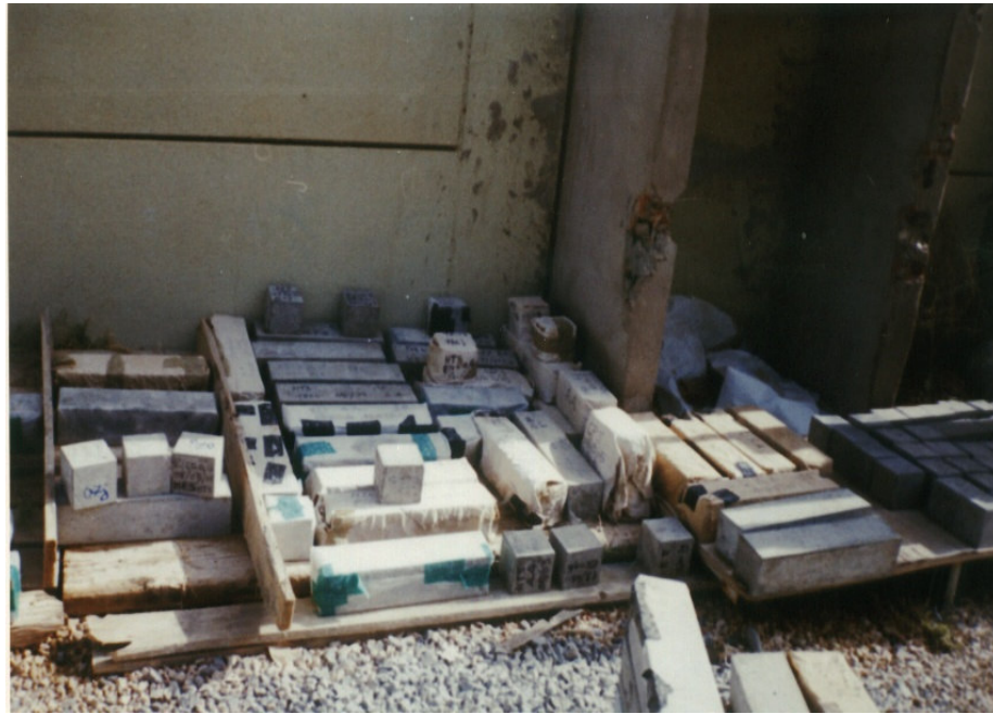
Figure (17) : échantillons de béton prismatiques et cubiques durcis sous différentes cures à différents âges
