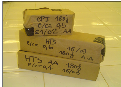
Photo (4) : épreuves de béton (10x10x10) et (10x10x40) cm 3 couvertes par du carton
