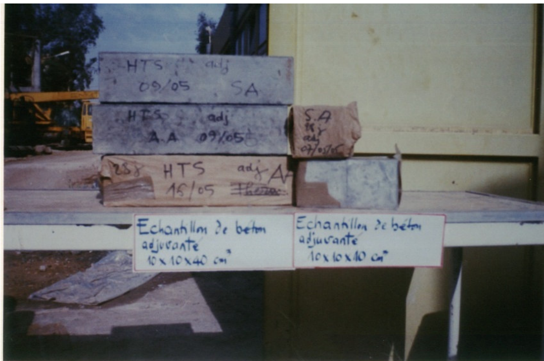
Figure (24) : échantillons de béton adjuvanté prismatiques et cubiques durcis sous différentes cures à 28 jours
