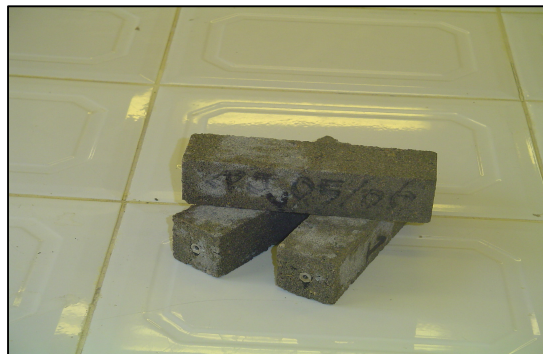
Photo (3) : éprouvettes prismatiques de mortier (7x7x28) cm 3 munis de plots mises dans l'enceinte d'étuvage.
