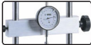
62-00035 Détail du comparateur analogique
